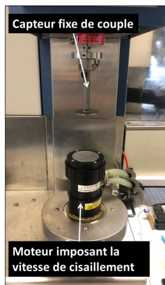
Figure 8. Photographie du rhéomètre rotatif équipé de la géométrie classique plan-plan.
