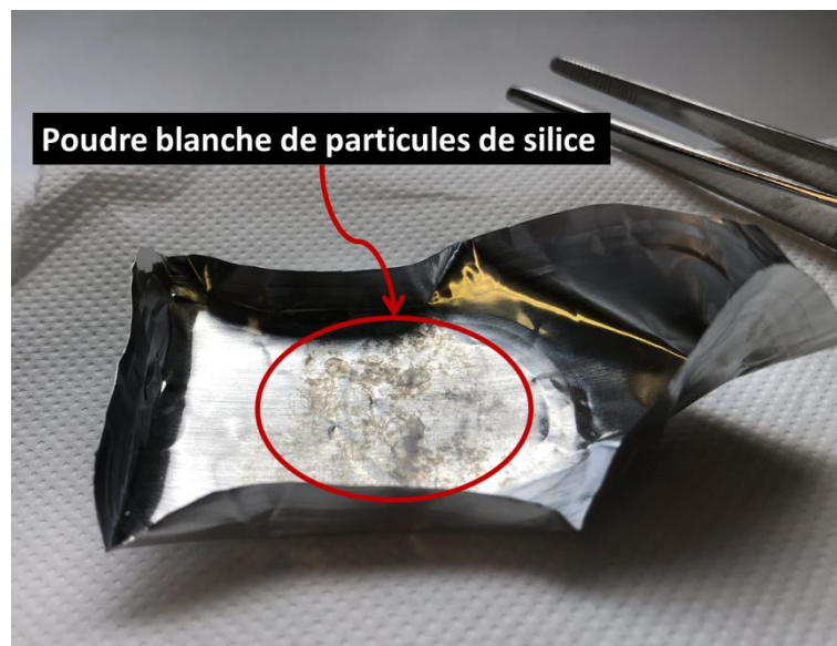
Figure 12. Photographie de la capsule métallique utilisée pour la gravimétrie avec les particules de silice sèches. Une poudre blanche peut être observée à la surface de la capsule.
