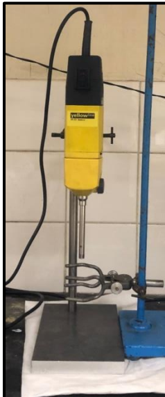
Figure 1. Photographies illustratives des (a) rotor-stator et (b) sonicateur utilisés dans les procédés d'émulsification.
