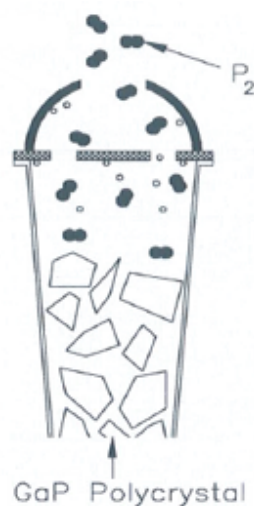
Figure 2.2 : Schéma du fonctionnement de la cellule à décomposition de GaP [117].
