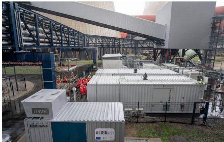
Figure 1.30 : Installation pour la synthèse du DME dans le projet ALIGN-CCUS (align-ccus.eu).
