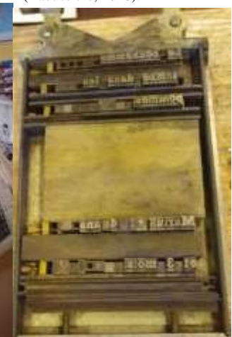
(21) Le texte composé est disposé sur la presse. (Rabussière, 2018).
