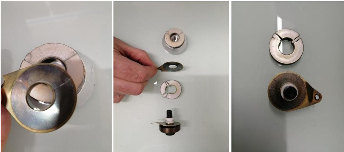
Figure V. 38. Dégradation d'un transducteur 45 kHz
