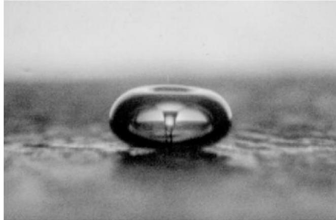
Figure I. 7. Photographie de l'implosion d'une bulle de cavitation et du micro-jet de fluide se formant en son centre (Poncet and Poncet 2021)
