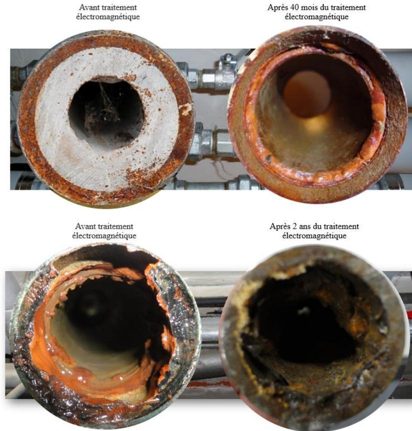
Figure IV. 23. Des conduites avant et après l'application du traitement électromagnétique
