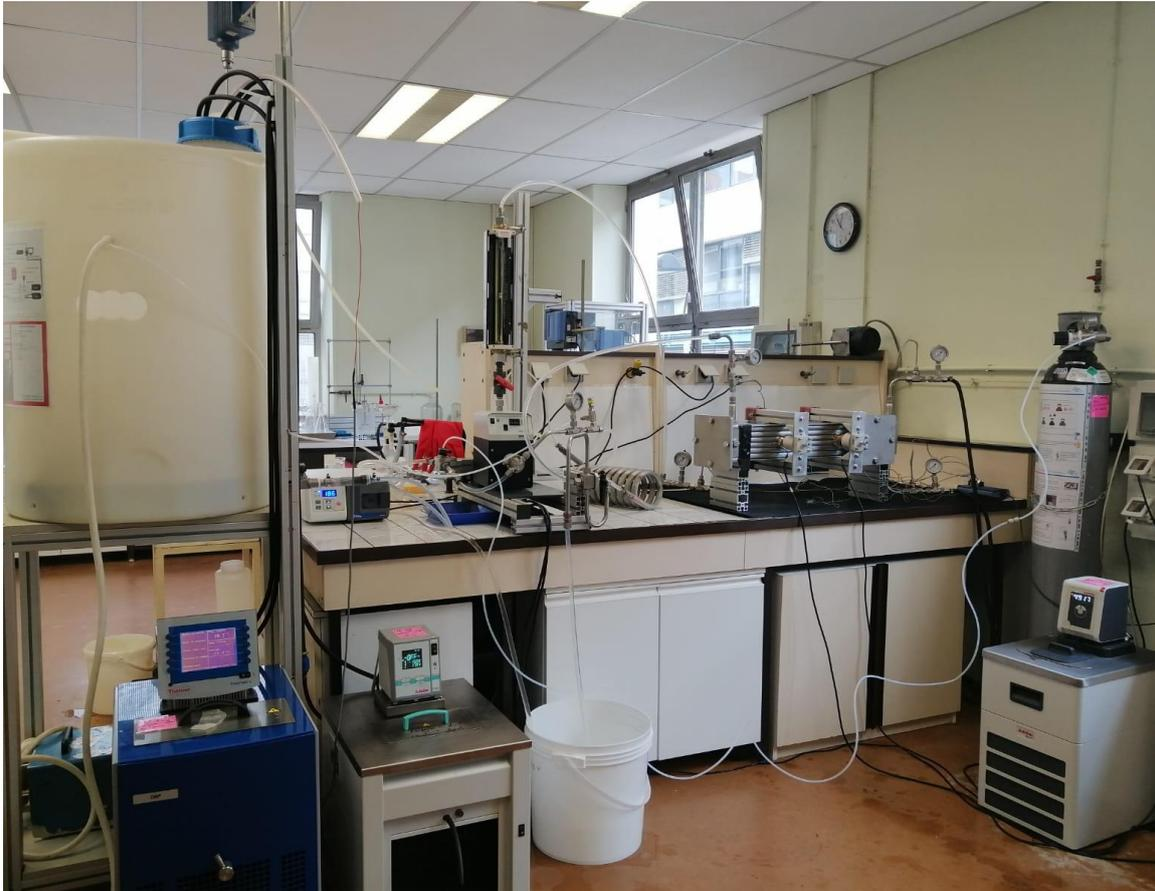
Figure VI. 33. Pilote échangeur platulaire avec deux transducteurs de fréquence différente
