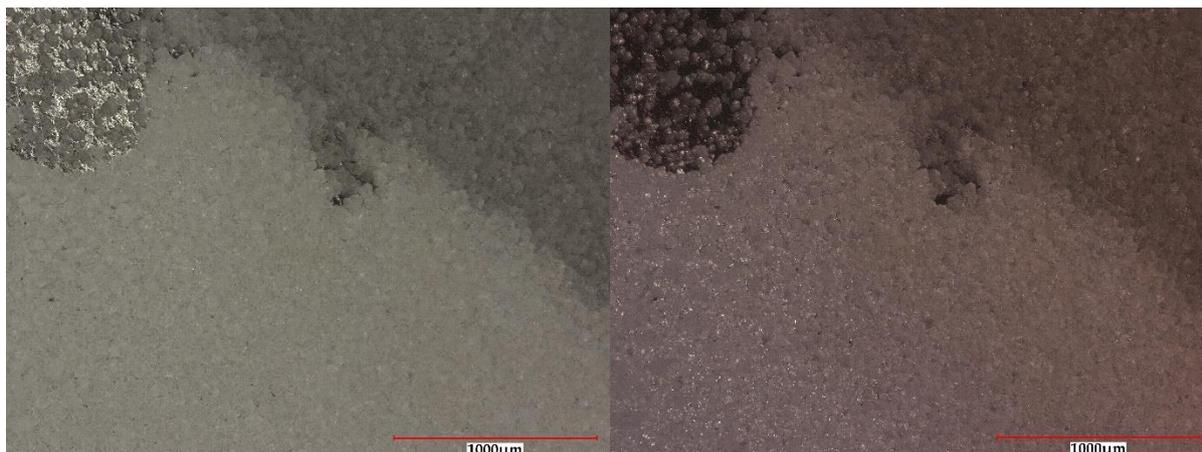
Figure IV. 5. Imageries du dépôt à l'entrée du premier compartiment, sans traitement physique, analysé au microscope numérique 3D sous lumière polarisée.  $[Ca^{2+}]_{initial} = 126,45 \text{ mg.L}^{-1}$ ;  $[Ca^{2+}]_{final} = 73,40 \text{ mg.L}^{-1}$
