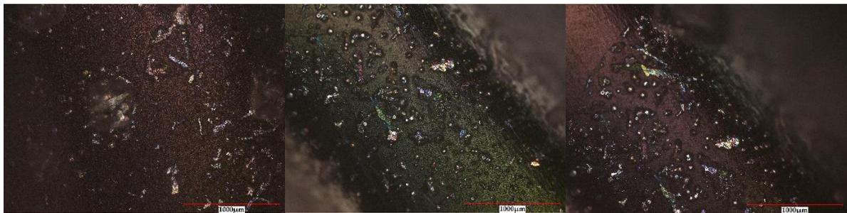
Figure V. 21. Imageries au microscope numérique 3D sous lumière polarisée du dépôt en sortie du premier compartiment froid en utilisant l'eau de mer.  $\text{pH} = 7,91$  ;  $[\text{Ca}^{2+}]_{\text{initial}} = 515,9 \text{ mg.L}^{-1}$  ;  $[\text{Ca}^{2+}]_{\text{final}} = 659,8 \text{ mg.L}^{-1}$  ;  $[\text{Carbonate}]_{\text{initial}} = 41,45 \text{ mg.L}^{-1}$  ;  $[\text{Carbonate}]_{\text{final}} = 43,27 \text{ mg.L}^{-1}$
