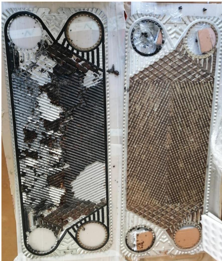
Figure VI. 38. Plaques entartrées de l'échangeur témoin du site lorrain
