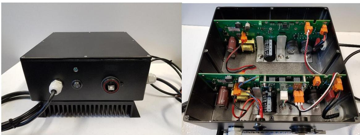
Figure VI. 7. Boîtier générateur des ondes ultrasoniques en mode simultané
