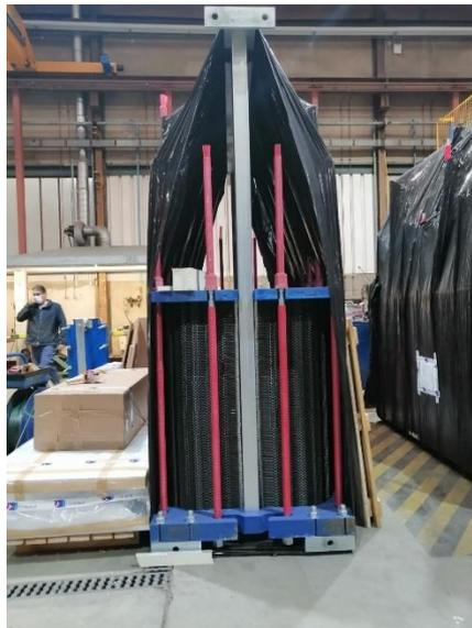
Figure II. 21. Photographie d'un échangeur de chaleur à plaques et joints type BAS\*300\*2120\*B\*P\*431 5L de la société Barriquand
