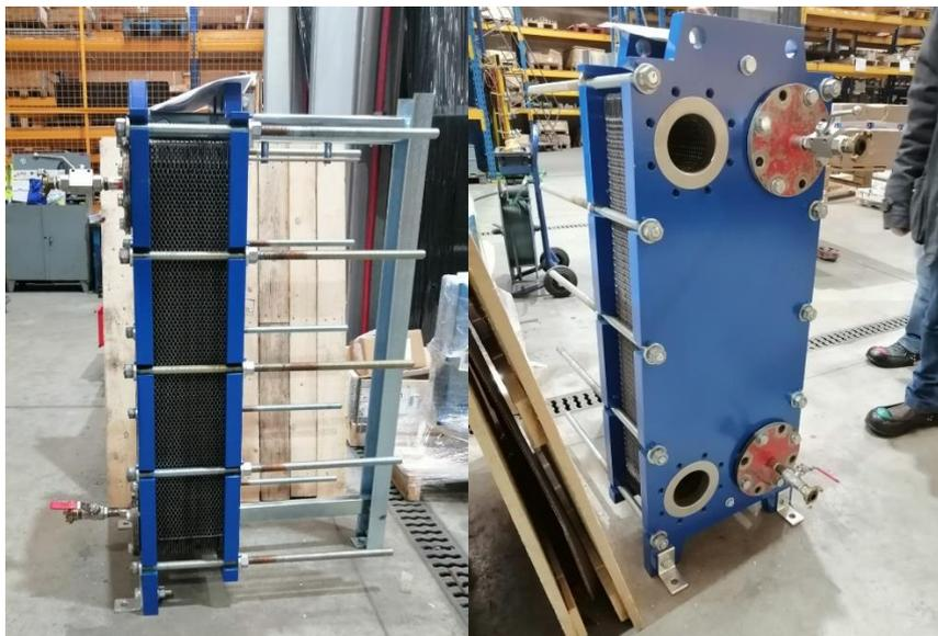
Figure II. 22. Photographie d'un échangeur de chaleur à plaques et joints type *BAS\*150\*1292\*G\*P\*138 6 ML57* de la société Barriquand
