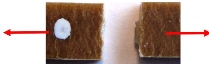
Figure III-12 : Specimen endommagé (*thèse, F. Gehring*)
