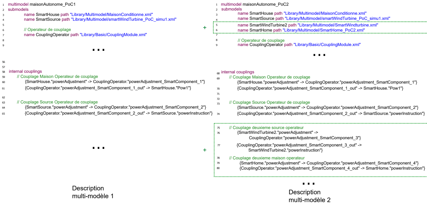
FIGURE 6.12 – Illustration d’ajout de composants dans la description des multi-modèles informatiques (de 6.6 à 6.10).
