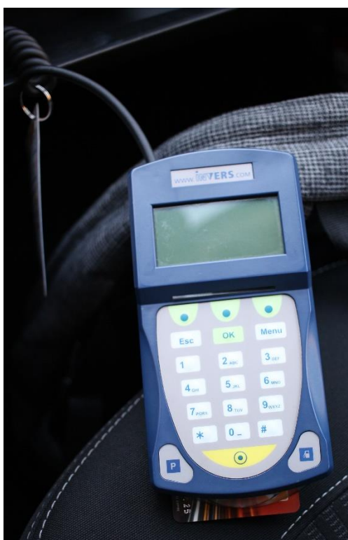
Figure 24. Photo de l'ordinateur de bord (aussi appelé « boîtier ») d'une voiture Citiz. On voit en haut à gauche le câble qui le raccorde à la boîte à gant et au module informatique de la voiture. On voit en bas la carte essence.
