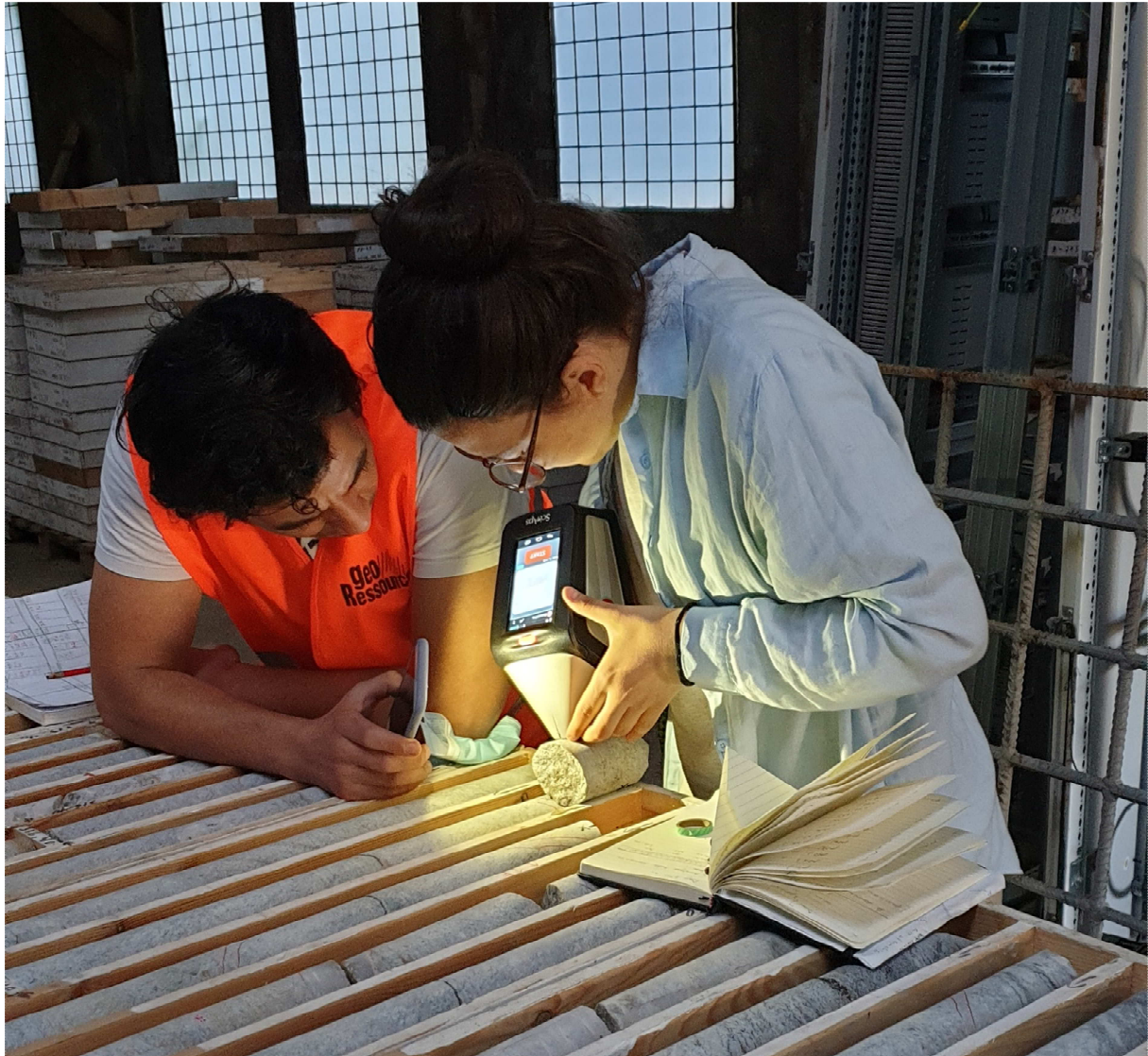
Figure 40 : prise de mesures pLIBS sur les carottes du gisement de San Finx, Espagne. Les mesures ont été prises à intervalles réguliers d'un centimètre en partant d'un contact veine minéralisée-roche encaissante. Les données ont été ensuite traitées pour qu'à chaque point d'analyse soit associé un minéral (projet NEXT). Photo J. Cauzid
