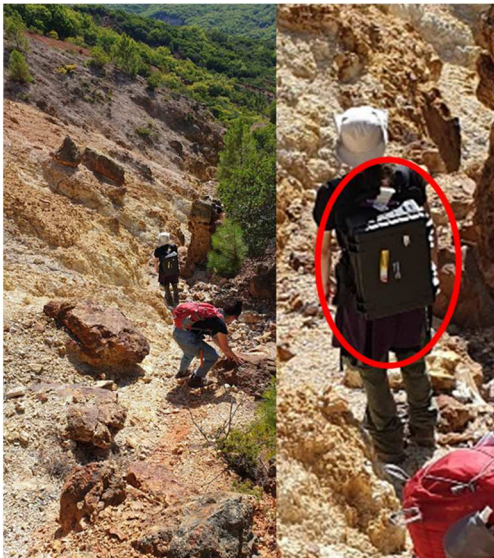
Figure 37 : valise de transport avec harnais de type sac-à-dos de randonnée. Ici sur le prospect de Sapes, Grèce avec les étudiants de Nancy, Thessalonique, Athènes et Erlangen (projet ARTeMIS). Photo J. Cauzid
