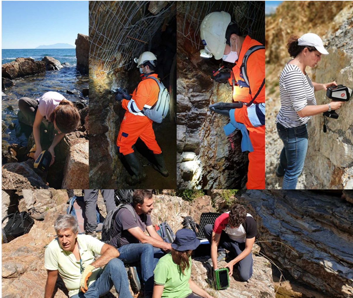
Figure 4 : en-haut de gauche à droite: mesure de veines de quartz à molybdénite par pXRF à Maronia (Grèce, projet ARTeMIS), meulage de la surface pour préparer les mesures pVNIR-SWIR et mesures pVNIR-SWIR dans la mine de San Finx (Espagne, projet NEXT), mesure pLIBS sur la pegmatite à lithium de Bajoca (Portugal, projet LIGHTS). En-bas : mesure par pRaman sur les encaissements du prospect de Kallindiri (Grèce, projet ARTeMIS).
