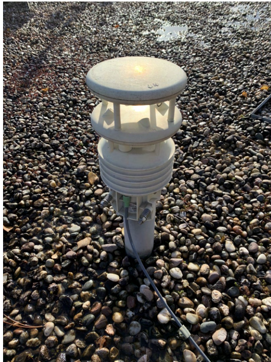
(b) Photographie de la situation Lufft installée sur la parcelle Gravier . La partie supérieure est composée de l'anémomètre pour la mesure de la vitesse de l'écoulement d'air, la partie située juste en-dessous permet d'acquérir les mesures de température et d'hygrométrie de l'air.
