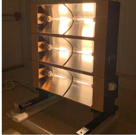
(b) Source lumineuse Deltalab composée de 6 lampes halogènes. La lumière est dirigée vers le panneau photovoltaïque à l'aide de miroirs paraboliques.
