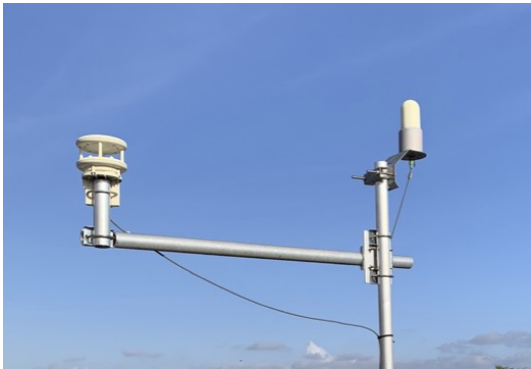
(a) Photographie du pluviomètre R2S de la marque Lufft et du capteur de vitesse WS200-UMB installé sur un mât à 2 m de hauteur sur la parcelle Gravier .
