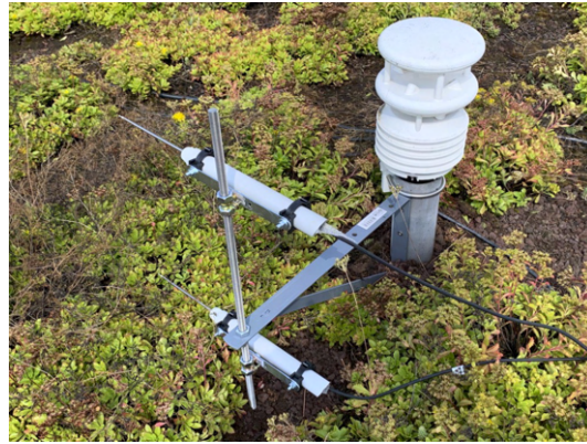
(b) Positionnement des sondes à boule chaude 5 et 6 au niveau de la station météorologique Lufft. Les sondes sont positionnées sur une tige filetée solidaire d'une équerre.
