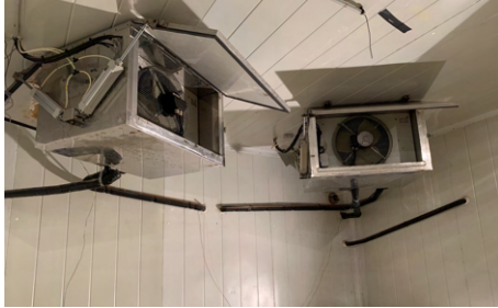
(a) Photographie des deux évaporateurs dans la chambre climatique du Cere-ma (Tomblaine) permettant une régulation de la température d'air entre -30^{\circ}\text{C} et 30^{\circ}\text{C} .
