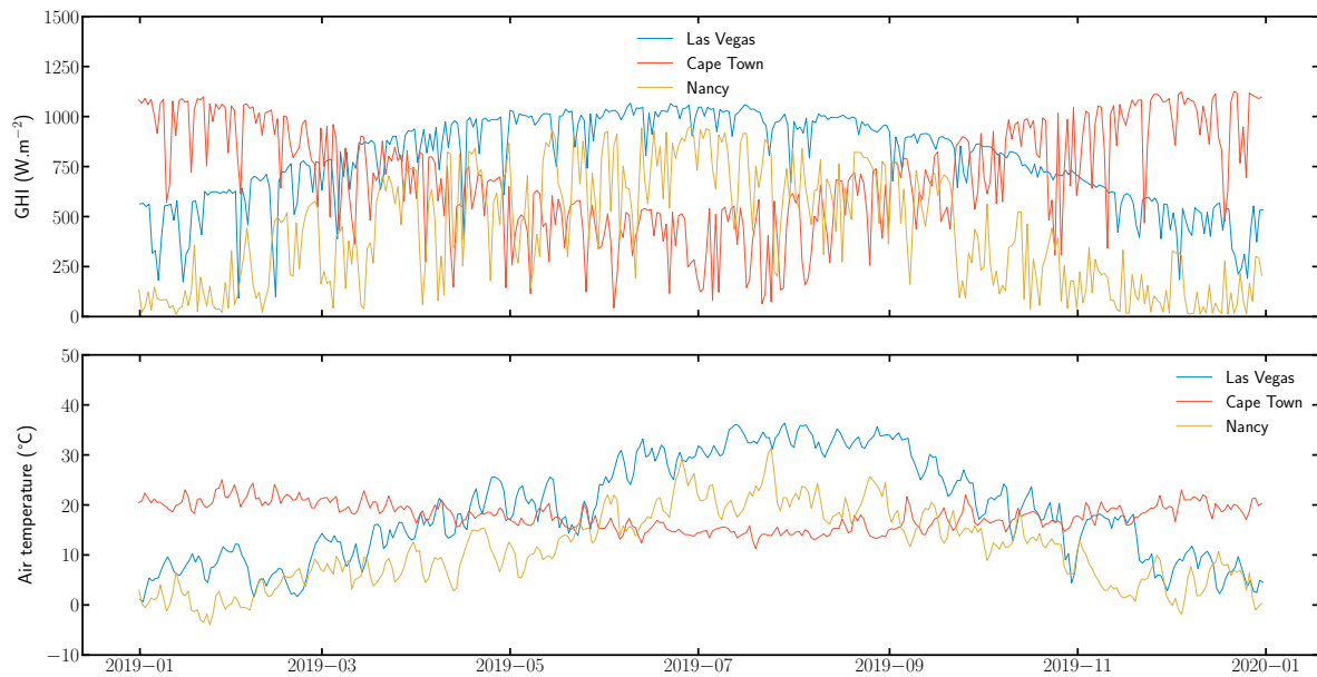
FIG. 5.12. : Données météorologiques (rayonnement solaire global horizontal, température de l'air et vitesse du vent) pour l'année 2019 à Las Vegas, Le Cap et Nancy. Pour les données de rayonnement, le maximum quotidien est affiché et pour la température de l'air, la moyenne quotidienne est tracée
