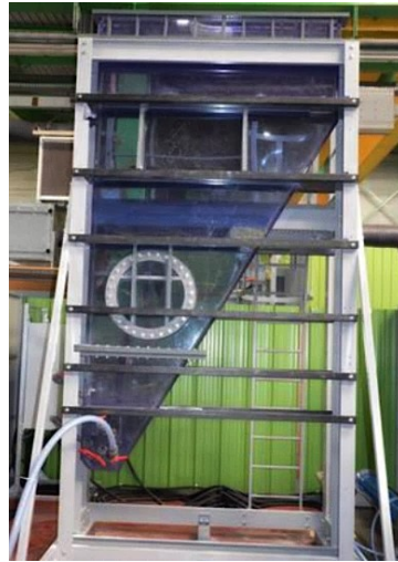
FIGURE 1.2. Prototype original du digesteur exploité dans le Hall de Recherche de Beaumont-Hague par ORANO. Le programme d'essais réalisé au CEA s'est largement inspiré des caractéristiques de cette configuration pour mettre en place au laboratoire les expériences de corrosion-érosion.
