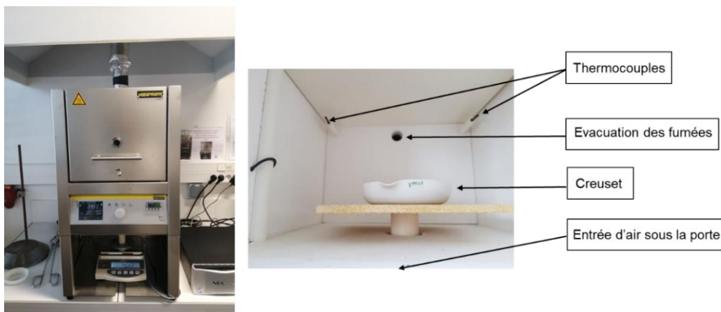
Figure 35 : Macro thermogravimétrie (four Nabertherm-balance Kern)
