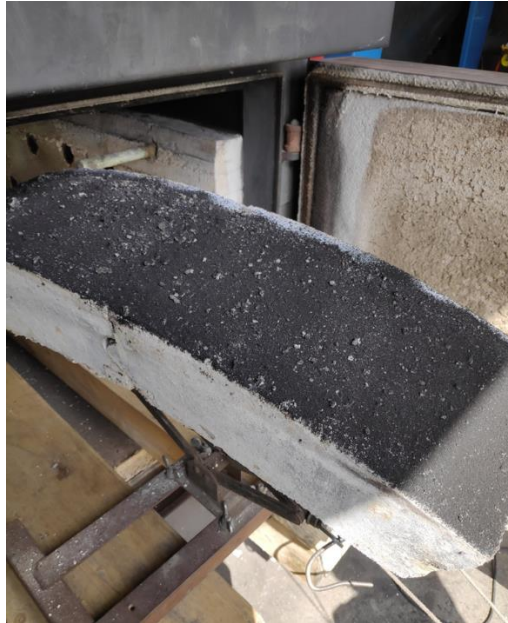
Figure 28 : La voute démontée avec les cendres déposées après un essai de combustion (zone 4)
