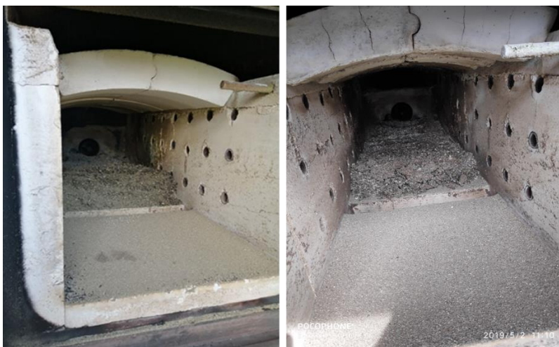
Figure 27 : Photos de chambre de combustion avec les cendres déposées après un essai de combustion (zones 1, 2 & 3)
