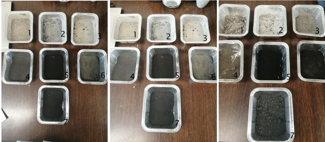
Figure 31 : Echantillons de cendres prélevés pour les différents points de prélèvements après chacun des 3 premiers essais de combustion
