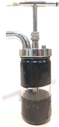
Figure 54 : Atomiseur utilisé pour les résines (CH Technologies, Collison Nebulizer).
