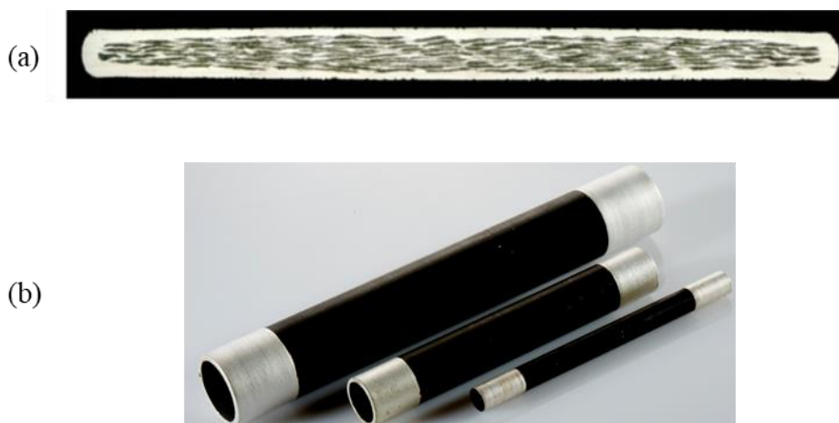
Figure I.15 (a) Vue en coupe d'un ruban Bi-2223 de Sumitomo Electric Industries [98]. (b) Amenées de courants en massif Bi-2223 de CAN Superconductors [99].
