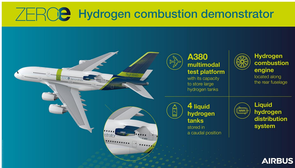
Figure I.5 Présentation du démonstrateur volant ZEROe embarquant un moteur à hydrogène sur un A380 [23].
