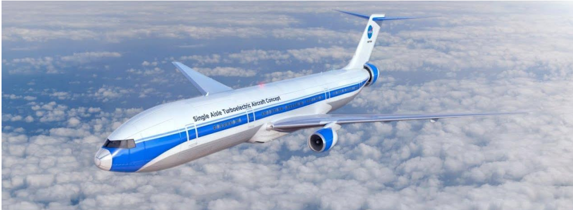
Figure I.8 Concept NASA STARC-ABL de propulsion partiellement turboélectrique avec un moteur électrique de 2-3 MW disposé à l'arrière de l'avion afin de réaliser la BLI [29].
