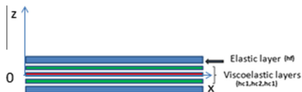
Figure 24 : Représentation schématique d'une structure sandwich à cœur viscoélastique multicouche [112]
