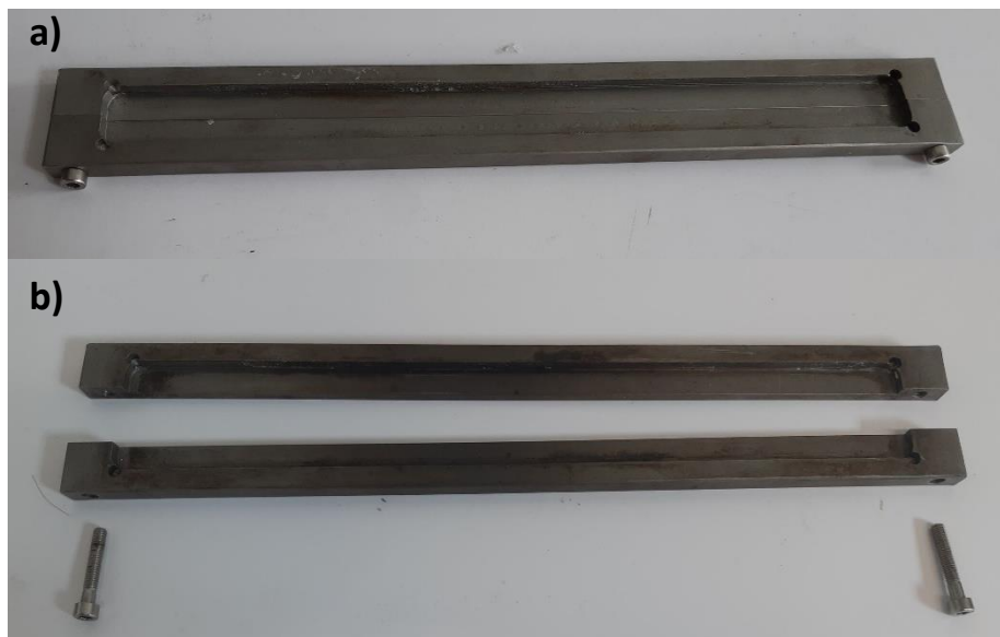
Figure 42 : Photos du moule en acier pour la fabrication des poutres sandwichs, assemblé (a) et désassemblé (b)
