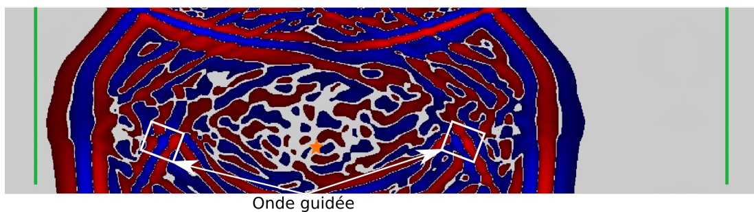
FIGURE 4.18 – Image de champ d'onde de la simulation directe pour la source S_5 . Les carrés blancs indiquent l'onde guidée qui est à l'origine de la bonne reconstruction observée pour cette source.
