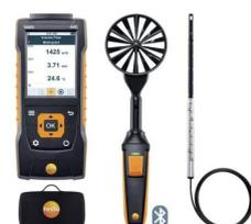
(b) Vane anemometer (Testo)
