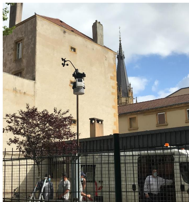
Figure 133 : la station Vantage Pro 2 plus implantée dans la cour de l'école maternelle Saint-Martin.
