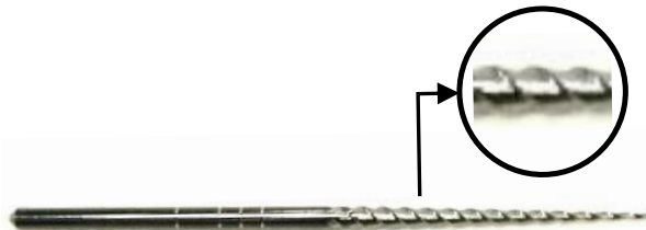
FIGURE 2.28 – Lime endodontique 25-06 à section triangulaire en NiTi polycristallin utilisée pour les traitements thermiques ( d'après Abdelmomen (2023)).
