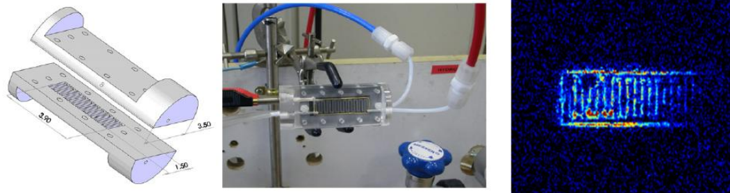
Figure 19. Design et photographie du prototype de pile à combustible développé au LEMTA lors du travail de thèse de Jérôme Bedet. A droite : image IRM dans le plan transverse montrant la distribution d'eau pendant le fonctionnement. Images issues des références [83, 84].
