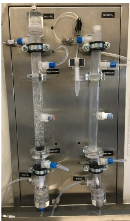
Figure A3.3. Dispositif expérimental – Réacteur catalytique continu. Le réacteur de gauche est destiné à l'ozonation catalytique, celui de droite à la réduction de micropolluants par l'hydrogène.
