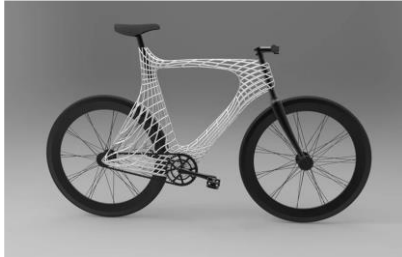
Réalisation d'un cadre de vélo par design génératif
