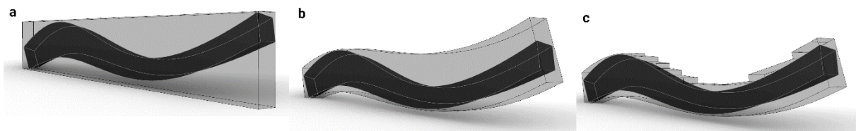
Figure 83. Types de bruts des poutres en bois lamellé-collé sélectionnables par le concepteur (a : brut de poutre rectiligne ; b : brut de poutre à simple courbure ; c : brut de poutre à simple courbure, à inertie variable)
