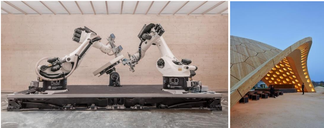
Figure 14. Buga Wood Pavilion réalisé par l'ICD en collaboration avec l'IKTE de l'Université de Stuttgart. Le projet est réalisé avec une plateforme de fabrication robotisée d'assemblage et de fraisage des composants de la coque en bois segmentée matérialisant le pavillon. La flexibilité de production des technologies des outils de l'information permet la création de nouvelles spatialités (Wagner et al., 2020).
