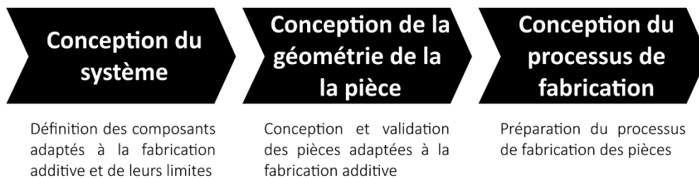
Figure 26. Étapes chronologiques du processus de Design for Additive Manufacturing explorées dans les travaux de recherche selon Wiberg. Adapté d'après (Wiberg et al., 2019)
