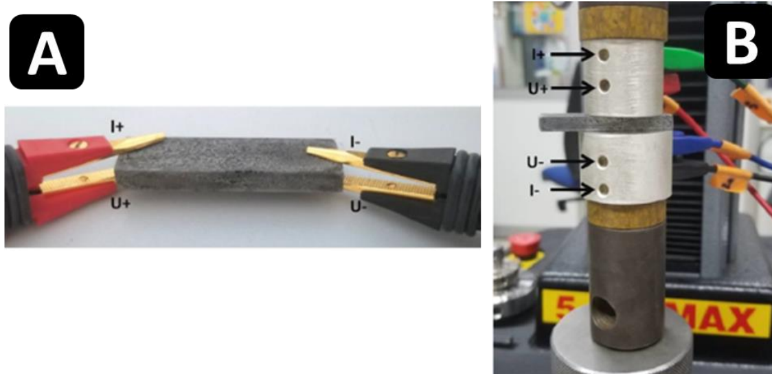
Figure VI.1. (A) Montage de type 4 points pour l'évaluation de la conductivité de surface des échantillons. (B) Montage de mesure de la résistance de contact sous charge des échantillons PEO, permettant l'évaluation de la conductivité en volume des échantillons.
