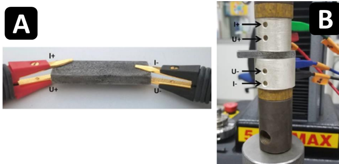
Figure VI.1. (A) Montage de type 4 points pour l'évaluation de la conductivité de surface des échantillons. (B) Montage de mesure de la résistance de contact sous charge des échantillons PEO, permettant l'évaluation de la conductivité en volume des échantillons.
