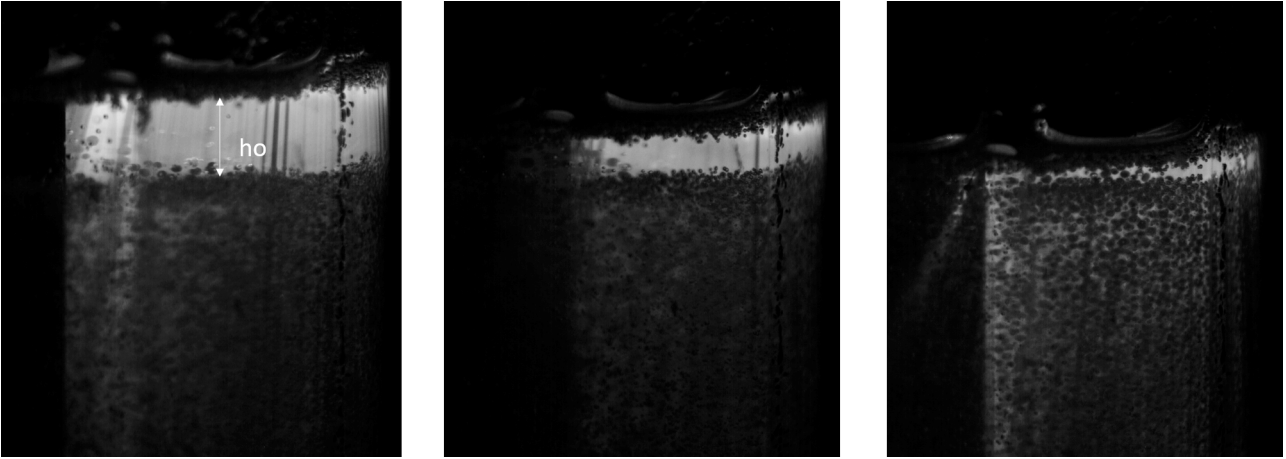
Figure 8.5 Aperçu de la diminution de la hauteur du liquide surnageant grâce à une pipette afin de changer la fraction volumique de l'échantillon. h_0 est la hauteur du surnageant de la fraction volumique initiale, pour une coupe de caméra centrale et transversale.
