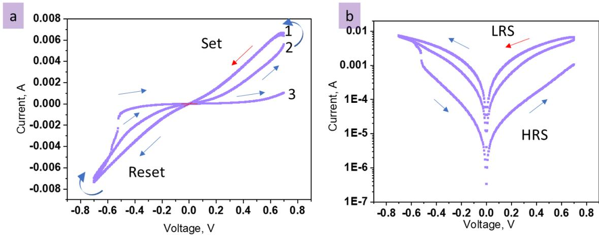
Fig. A7: Courbes I-V caractéristiques du dispositif MIM basé sur un matériau BOC à  $V_{max}$  700 mV. a) et b) courbes I-V typiques du dispositif ; les courbes originales en a) représentent un processus de commutation à 2 cycles (boucle du 1er cycle représentée par 1-2, boucle du 2ème cycle par 2-3. Les mêmes courbes sont présentées en échelle logarithmique en b). Elles montrent des états évidents de résistance faible et élevée (notés LRS et HRS).
