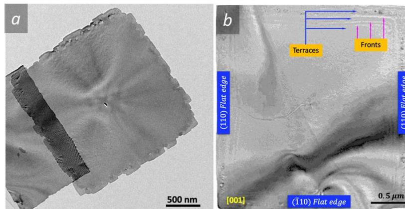
**Fig. 3:** Images TEM en champ clair montrant la forme carrée des nanofeuillets de BOC avec **a)** des bords dentelés par des coins (terrasses et fronts) et **b)** des bords plats (sans coins apparents). On peut remarquer la présence de terrasses et de fronts sur la surface projetée.
