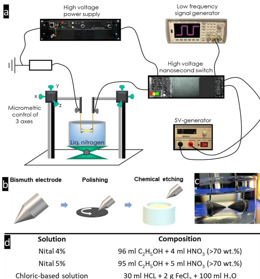
Fig. 1 : a) Schéma de l'installation expérimentale, ici présentée dans le cas de l'azote liquide. b) Prétraitement des électrodes gravée dans l'une des solutions chimiques présentées en d). c) Image des électrodes dans de l'eau Milli-Q. d) Composition des quatre solutions chimiques testées dans cette étude.
