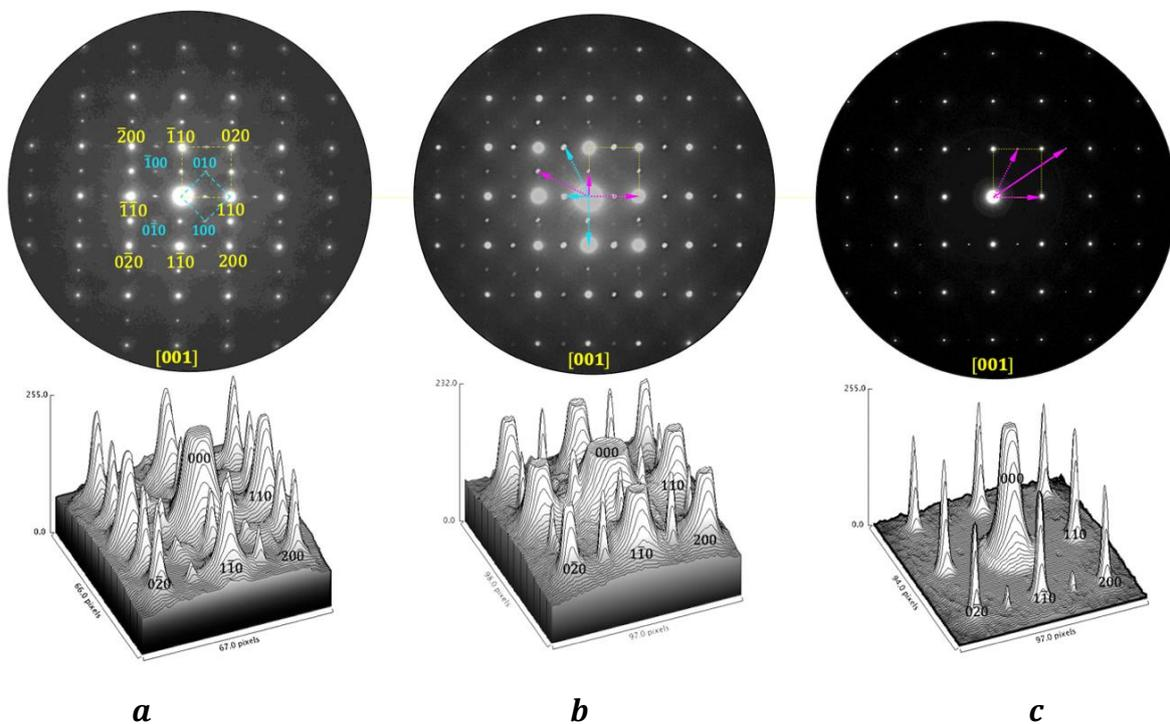
Fig. 5 : Origine des réflexions supplémentaires sur le motif de diffraction électronique enregistré le long de  $[001]$  sur différentes zones sous le faisceau électronique : **a**) transformation ordre-désordre (maille unitaire en cyan), **b**) et **c**) diffraction multiple mise en évidence par des vecteurs colorés en cyan et/ou en magenta.
