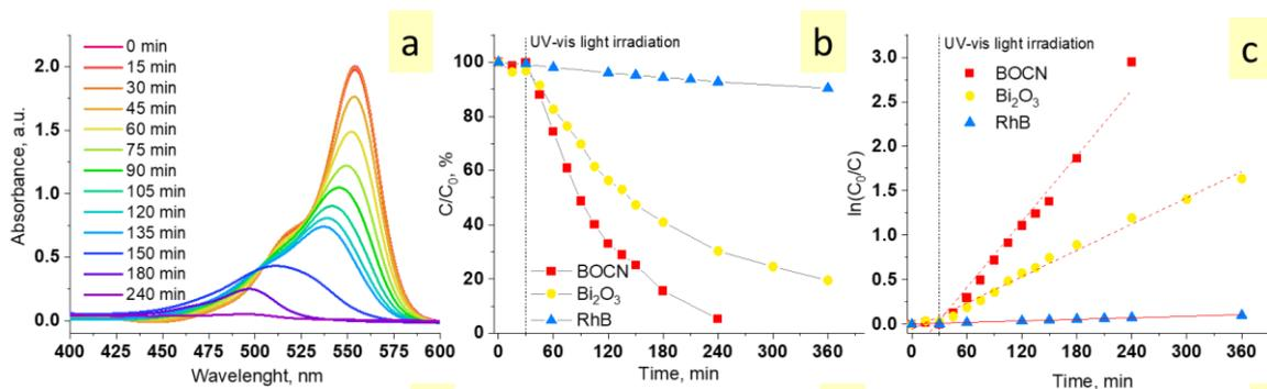
Fig. 6 : a) Évolution de l'absorbance de la Rhodamine B en fonction du temps d'exposition à la lampe Xe en présence de BOCN, b) Dégradation photocatalytique de la Rhodamine B en fonction du temps d'irradiation, sans catalyseur, en présence de BOCN et de nanoparticules commerciales de  $\text{Bi}_2\text{O}_3$ , c) Courbes cinétiques de la dégradation de la Rhodamine B.
