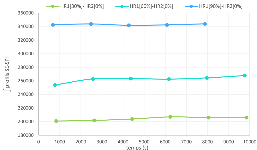
Figure V. 7 : Variation de l'intégrale des profils SE-SPI en fonction du temps pour de l'AME N1110/CC ( 0.3 \text{ mg}_{\text{pv}}/\text{cm}^2 ) lorsqu'elle est soumise aux étapes : HR1[30 %] – HR2[0 %], HR1[60 %] – HR2[0 %] et HR1[90 %] – HR2[0 %].
