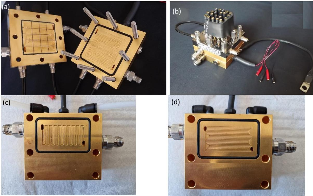
*Figure 2-12 : Image des différentes cellules avec leurs canaux d'alimentations. (a) : Image de la cathode segmentée (plaque à gauche) et cathode (plaque à droite). (b) : montage des deux plaques de la cellule segmentée. (c) : image du mono canal d'alimentation des gaz. (d) : image des 4 canaux serpentinaux et parallèles d'alimentation des gaz.*
