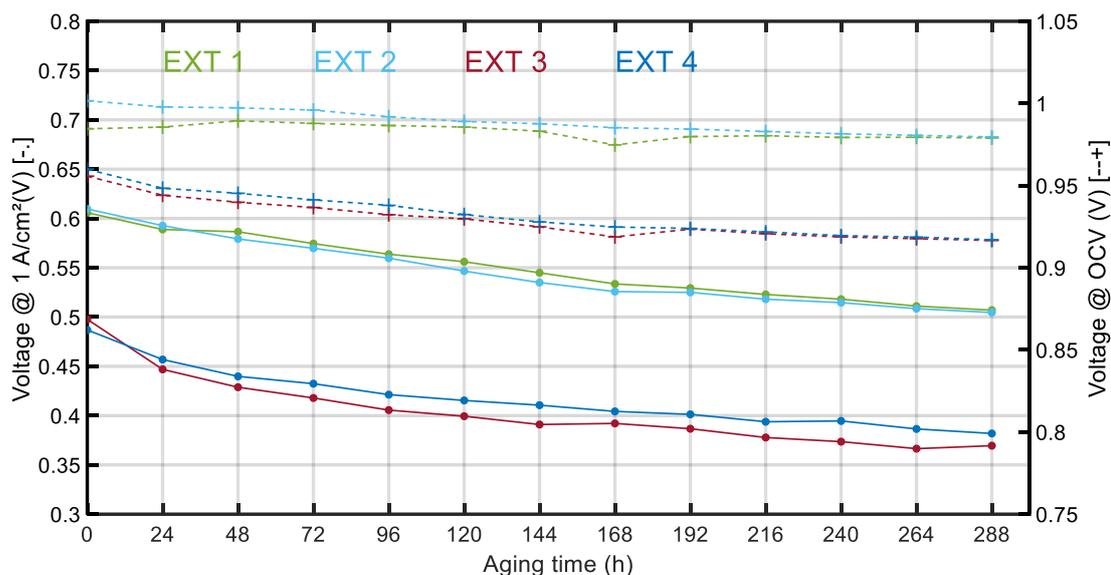
**Figure 5-10 :** Evolution de la tension de la pile à combustible lors d'un fonctionnement à 1A/cm<sup>2</sup> et l'OCV durant le protocole de vieillissement. Courbes en pointillé correspondent à l'évolution de l'OCV et les courbes en trait plein correspondent à l'évolution de la tension de fonctionnement à 1 A/cm<sup>2</sup>.
