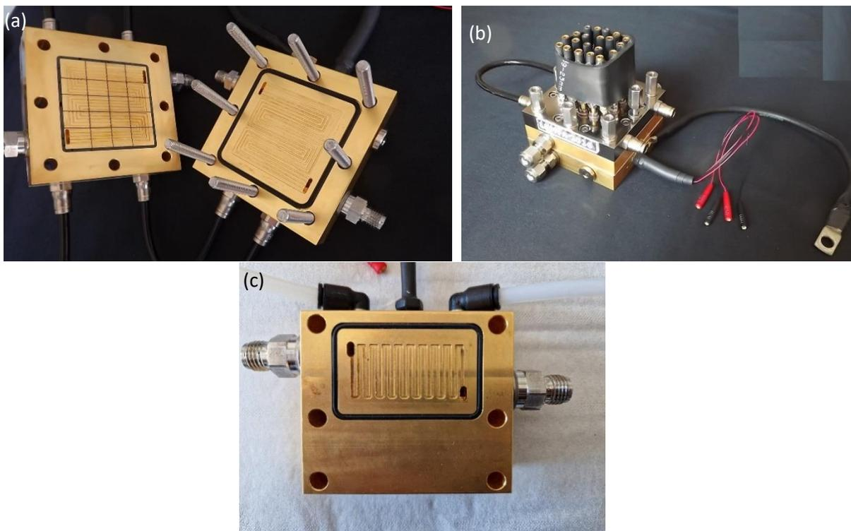
**Figure 5-1 :** Images des différentes cellules avec leurs canaux d'alimentation. (a) : Image de la cathode segmentée (plaque à gauche) et cathode (plaque à droite). (b) : montage des deux plaques de la cellule segmentée. (c) : image du mono canal d'alimentation des gaz.
