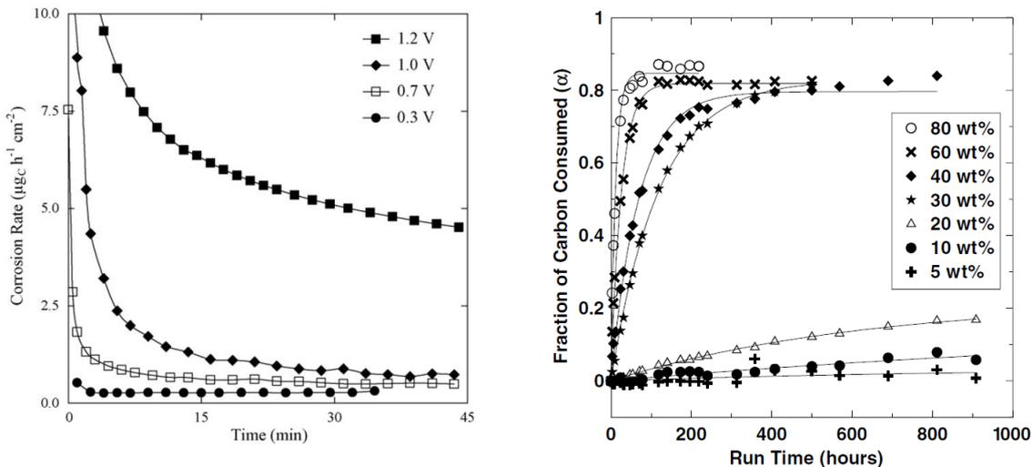
**Figure 1-17 :** Gauche : Taux de corrosion du carbone pour différents potentiels (compris entre 0.3 – 1.2 V) en fonction du temps. Droite : Fraction de carbone pour différents pourcentage massique de platine (compris entre 5-80%) en fonction du temps, à un potentiel de 1.2 V et une température de 195°C. Figures tirées de [121] et [120].
