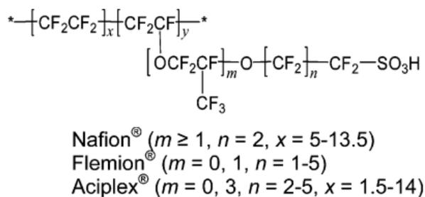
Figure 1-7 : Structure des membranes à chaînes longue [43].
