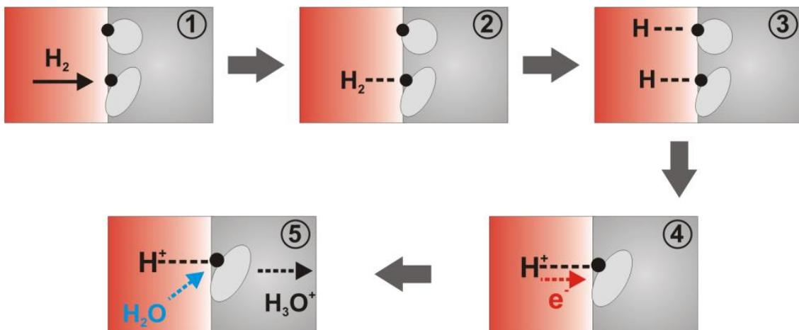
**Figure 1-3 :** Représentation schématique de chaque étape de la réaction cinétique. 1 : Diffusion du gaz vers les sites actifs ; 2 : Adsorption ; 3 : Chimisorption ; 4 : Transfert de charge entre l'atome et le catalyseur ; 5 : Recombinaison. Notez qu'il s'agit d'une représentation simplifiée. Cette figure provient de [22].
