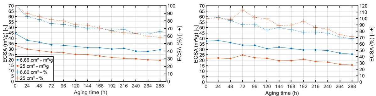
Figure 5-8 : Evolution de la surface active en m<sup>2</sup>/g<sub>Pt</sub> et en relative durant tout le test de vieillissement de 12j. Les courbes de gauche correspondent à l'évolution de la surface active à la cathode. Les courbes de droite correspondent à l'évolution de la surface active à l'anode. Les courbes en pointillé correspondent à l'évolution relative de la surface active en % et les courbes en trait plein correspondent à l'évolution en m<sup>2</sup>/g.
