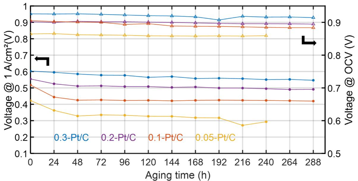
Figure 5-29 : Evolution de la tension de la pile à combustible lors d'un fonctionnement à  $1 \text{ A/cm}^2$  et à l'OCV durant le protocole de vieillissement. Courbes en pointillé correspondent à l'évolution de l'OCV et les courbes en trait plein correspondent à l'évolution de la tension de fonctionnement à  $1 \text{ A/cm}^2$ .
