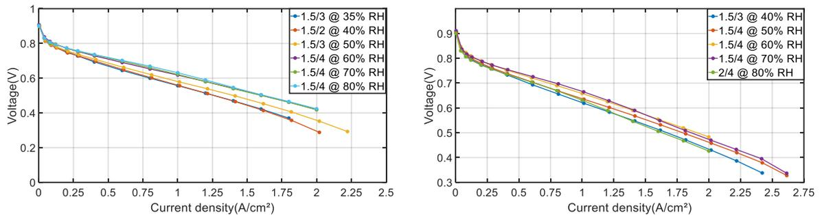
**Figure 4-13 :** Meilleures courbes de polarisation obtenues à  $T = 80^{\circ}\text{C}$  pour différentes valeurs d'humidité relative pour la cellule de 25 cm<sup>2</sup>. Courbes de gauche :  $P = 1,5$  bar, courbes de droite :  $P = 2$  bar.
