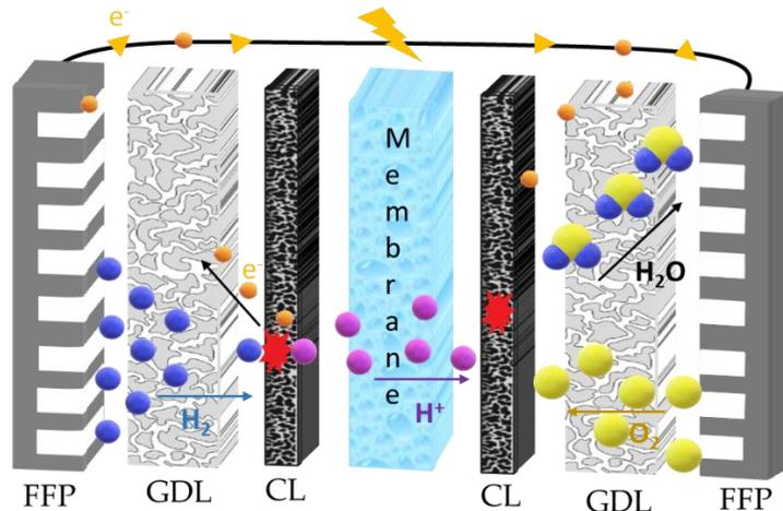
Figure 1-1 : Représentation schématique de la pile à combustible PEM alimentée en  $H_2$  et  $O_2$ .
