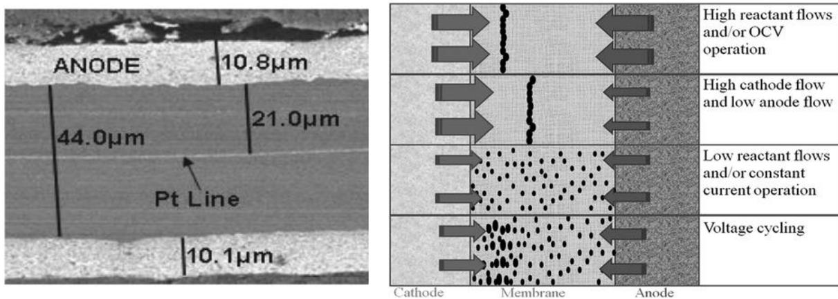
**Figure 1-16 :** Gauche : Coupe transversale d'une AME faite par MEB après un fonctionnement de 700h à l'OCV sous un flux de  $H_2/O_2$  aux conditions : 95°C, 100% HR et 300 kPaabs. Droite : Représentation schématique des différents comportements du platine dans la membrane dans conditions de fonctionnement. Images tirées de [47,119].
