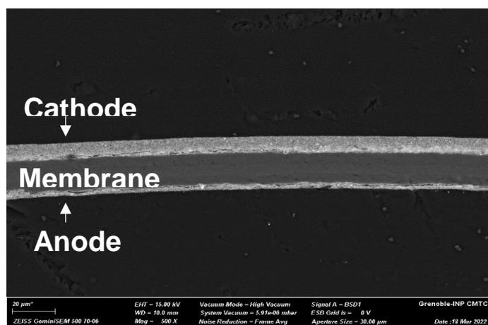
Figure 1-12 : Image faite par Microscopie Electronique en transmission (MET) d'un catalyseur Pt/C (gauche) [80]. Image d'une coupe d'AME faite par MEB.
