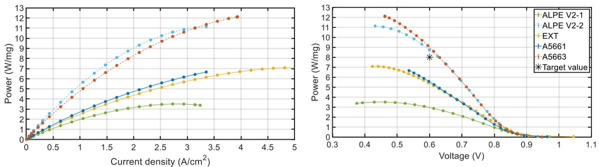
Figure 4-20 : Courbes de puissance obtenues à partir des courbes de polarisation de la Figure 4-19. A gauche : en fonction de la densité de courant. A droite : en fonction de la tension de la cellule.
