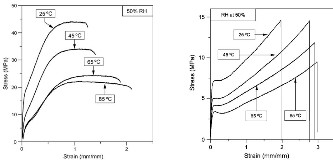
Figure 1-9 : Courbes de contrainte-déformation à 50% HR pour différentes températures. Gauche : Gore-Select. Droite : Nafion 112. Les figures proviennent de [76,77].
