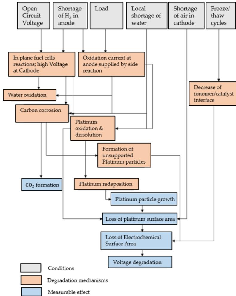
Figure 1-19 : Synthèse des cause et mécanismes de dégradation des électrodes à base de Pt/C pour les PEMFC proposée par Bruijn et al. Image tirée de [78].
