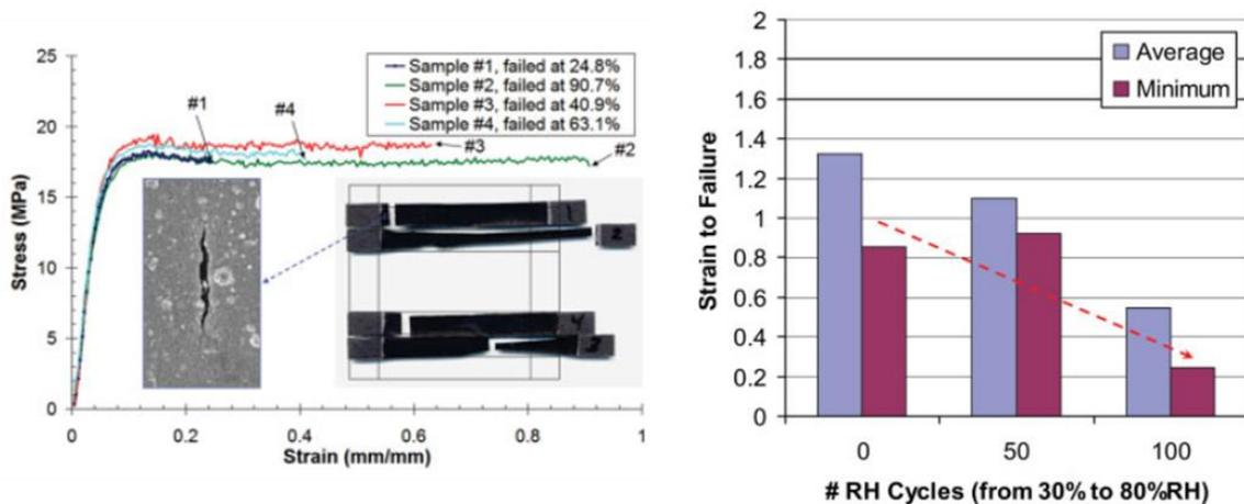
**Figure 1-8 :** Gauche : Courbes de contrainte-déformation de la membrane après 100 cycles entre 30% et 80% d'humidité relative, avec image Microscopie Electronique à Balayage (MEB). Test réalisé à 65°C. Droite : Valeurs moyennes et minimales de la déformation jusqu'à la rupture en fonction du nombre de cycles d'humidité relative. Ces images proviennent de [72].
