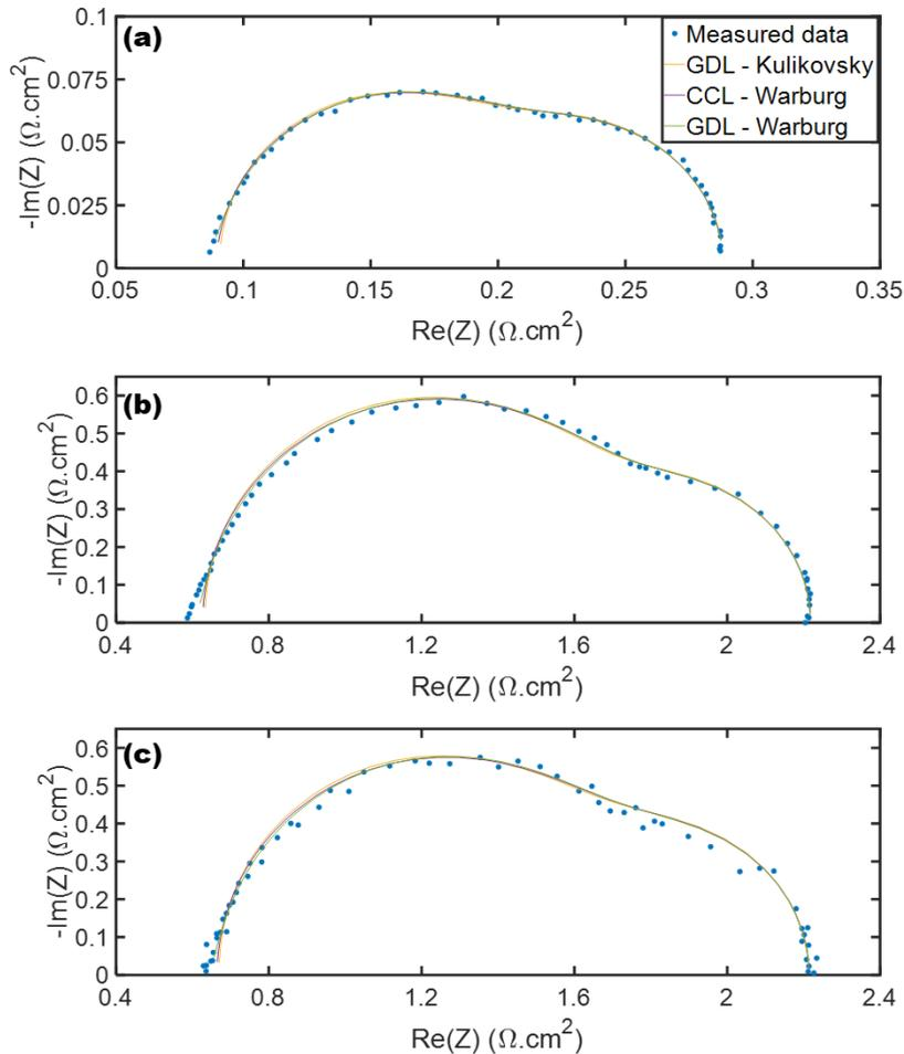
**Figure 3-6 :** Diagrammes de Nyquist des données d'impédance mesurées à  $0,5 \text{ A/cm}^2$  (sous  $\text{H}_2/\text{air}$ ) avec (a) la cellule A2 [3], (b) la cellule B - NR211 et (c) la cellule B - XL100 dans les conditions de fonctionnement indiquées dans la section 3.3.3- et les courbes de modélisation obtenues avec les différents circuits électriques équivalents représentés dans la Figure 3-2a et b (lignes pleines). L'anode est négligée.
