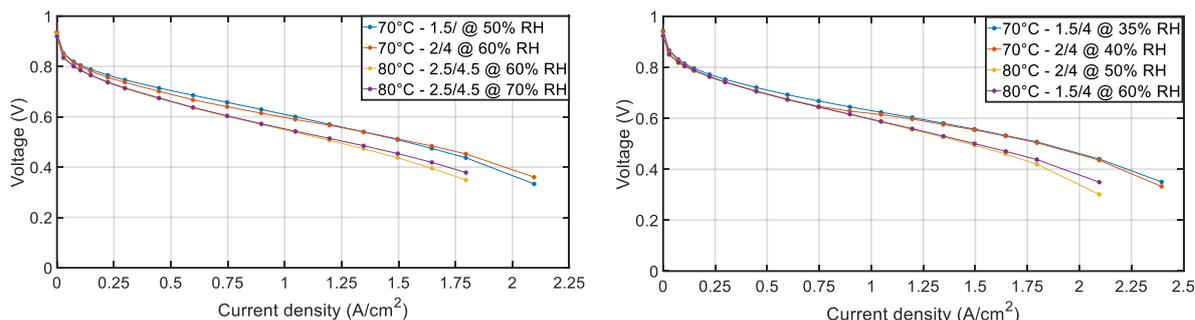
Figure 4-8 : Meilleures courbes de polarisation obtenues avec la cellule B. Comparaison entre  $T = 70^{\circ}\text{C}$  et  $T = 80^{\circ}\text{C}$ . Gauche :  $P = 1,5$  bar ; droite :  $P = 2$  bar.
