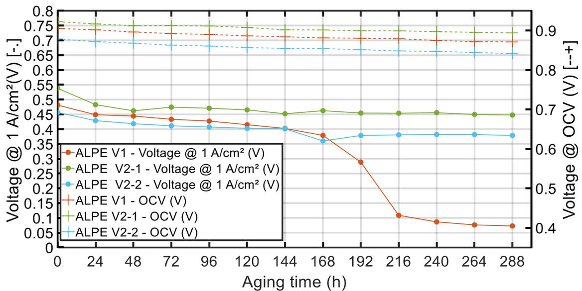
Figure 5-15 : Evolution de la tension de la pile à combustible lors d'un fonctionnement à  $1\text{A/cm}^2$  et l'OCV durant le protocole de vieillissement. Courbes en pointillé correspondent à l'évolution de l'OCV et les courbes en trait plein correspondent à l'évolution de la tension de fonctionnement à  $1\text{A/cm}^2$ .
