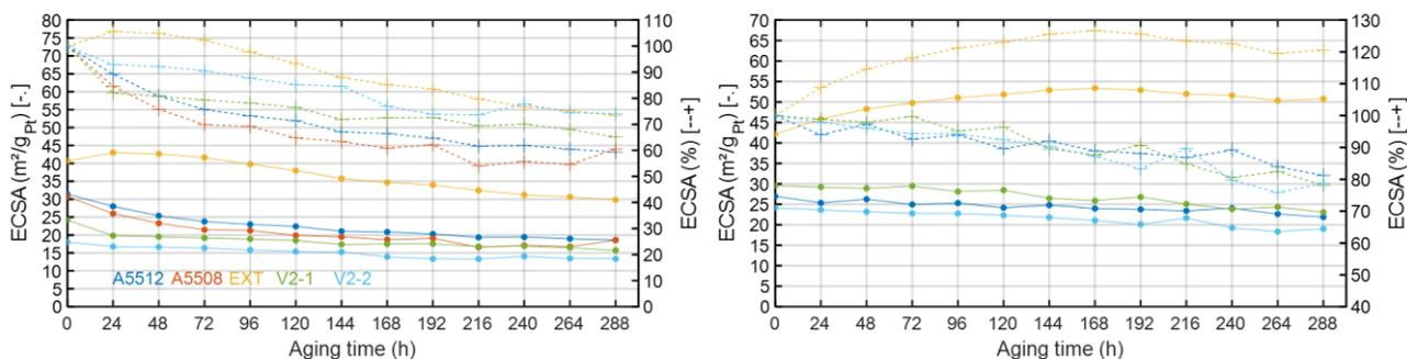
**Figure 5-21** : Evolution de la surface active en m<sup>2</sup>/g<sub>Pt</sub> et en relative durant tout le protocole. Les courbes de gauche correspondent à l'évolution de la surface active à la cathode. Les courbes de droite correspondent à l'évolution de la surface active à l'anode. Les courbes en pointillé correspondent à l'évolution relative de la surface active en % et les courbes en trait plein correspondent à l'évolution en m<sup>2</sup>/g.
