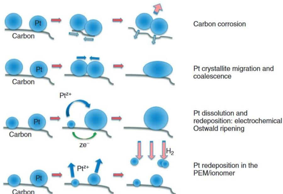
Figure 1-15 : Représentation schématique des quatre mécanismes de dégradation des électrodes à base de Pt/c. Image tirée [106].
