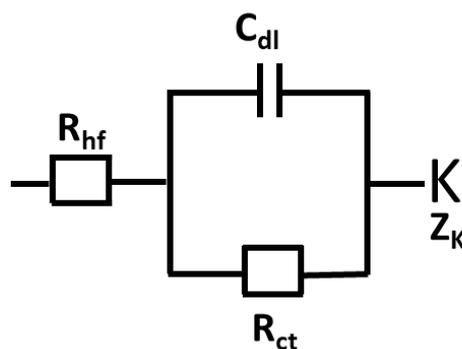
Figure 2-8 : Représentation d'un circuit de Randles modifié avec l'impédance de transport de l'oxygène – élément de Kulikovsky – limitation diffusion de l'oxygène par la GDL.
