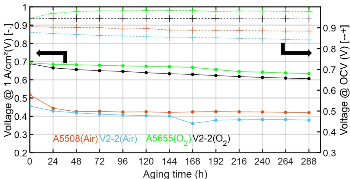
Figure 5-24 : Evolution de la tension de la pile à combustible lors d'un fonctionnement à  $1 \text{ A/cm}^2$  et à l'OCV durant le vieillissement. Courbes en pointillé correspondent à l'évolution de l'OCV et les courbes en trait plein correspondent à l'évolution de la tension de fonctionnement à  $1 \text{ A/cm}^2$ .
