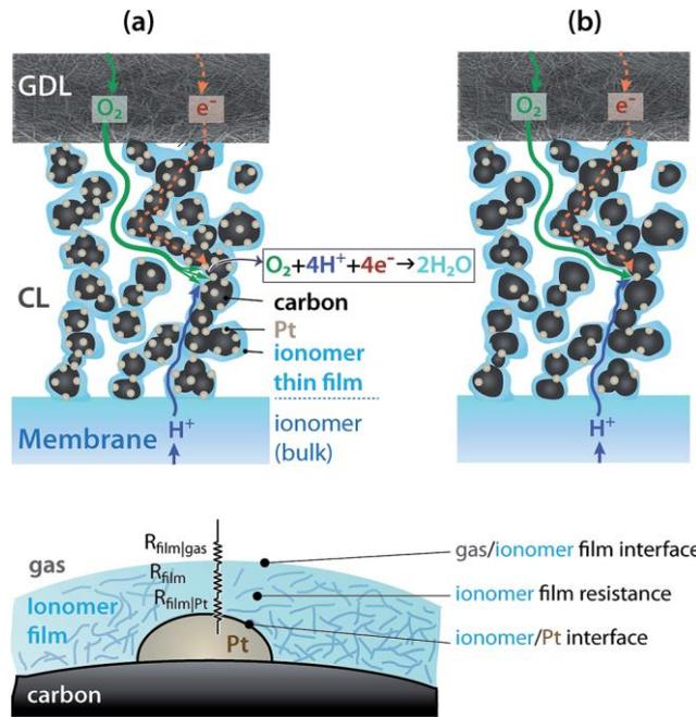
**Figure 1-24 :** Schémas de la structure poreuse de la pile à combustible et le transport de l'O<sub>2</sub> et les électrons à travers (a) une couche avec un fort chargement en platine et (b) une couche avec un faible chargement en Pt. (c) zoom sur le transport à travers le film de ionomère recouvrant le site de platine. Figures tirées de [190].
