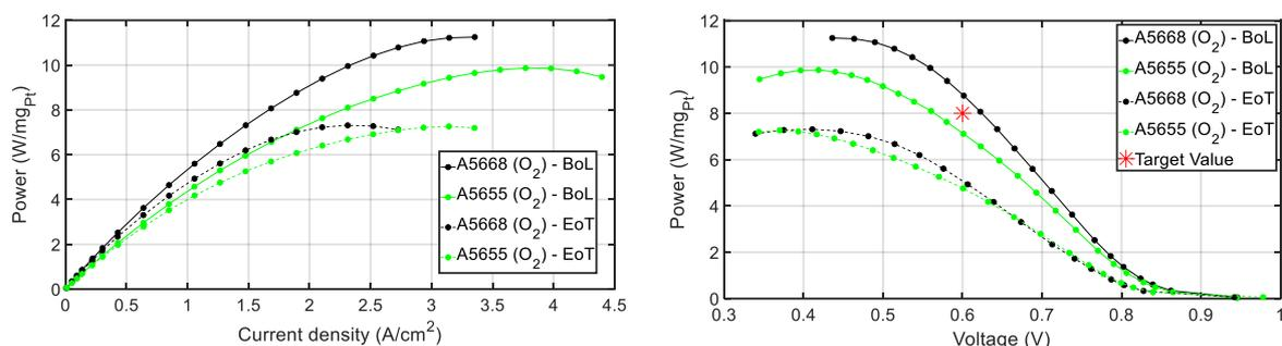
Figure 5-23 : Courbes de puissance obtenues avec les courbes de polarisation de la Figure 5-22. Figure de gauche : courbes de puissance (W/mg<sub>Pt</sub>) en fonction de la densité de courant (A/cm<sup>2</sup>). Figure de droite : courbes de puissance (W/mg<sub>Pt</sub>) en fonction du potentiel de la cellule (V).
