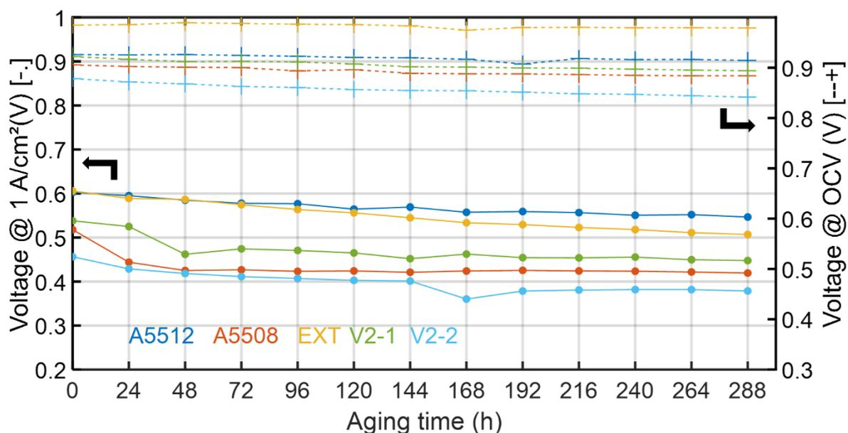
Figure 5-19 : Évolution de la tension de la pile à combustible lors d'un fonctionnement à  $1 \text{ A/cm}^2$  et l'OCV durant le protocole de vieillissement. Courbes en pointillé correspondent à l'évolution de l'OCV et les courbes en trait plein correspondent à l'évolution de la tension de fonctionnement à  $1 \text{ A/cm}^2$ .
