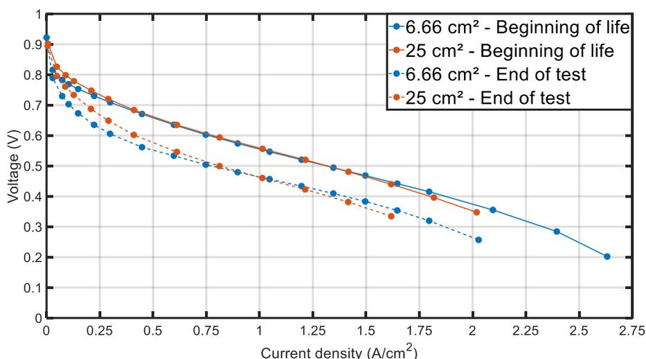
*Figure 5-5 : Courbes de polarisation en début de vie et fin de test pour les deux cellules. Les courbes en trait plein correspondent aux courbes de polarisation en début de vie. Les courbes en pointillé correspondent aux courbes de polarisation de fin de test. Courbes en bleu pour la cellule de 6,66 cm<sup>2</sup> et rouge pour la cellule de 25 cm<sup>2</sup>.*
