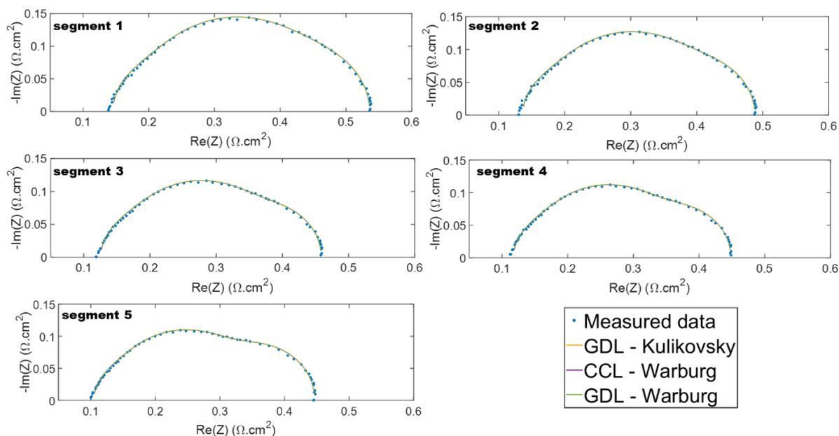
**Figure 3-5 :** Courbes de Nyquist des données mesurées sur les 5 premiers segments (entrée d'air/sortie d'hydrogène) de la cellule A1 à  $0,5 \text{ A/cm}^2$  ( $\text{H}_2/\text{air}$ ) dans les conditions de fonctionnement décrites à la section 3.3.3-. Les courbes de modélisation ont été obtenues avec les circuits électrique équivalent décrites dans la Figure 3-2.
