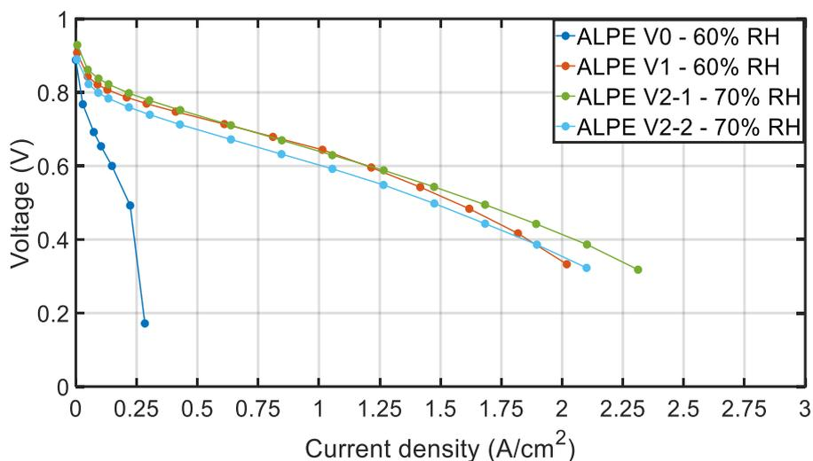
Figure 4-15 : Meilleures courbes de polarisation pour chaque AME du projet ALPE. Chaque AME fonctionne avec une stœchiométrie de 1,5/4 (H<sub>2</sub>/Air) à P = 2 bar et T = 80°C. ALPE V0 est réalisé avec la cellule A et V1 / V2-1 / V2-2 avec la cellule de 25 cm<sup>2</sup>.
