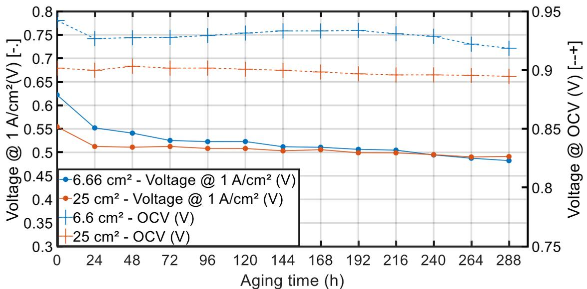
Figure 5-6 : Evolution de la tension de la pile à combustible lors d'un fonctionnement à 1A/cm<sup>2</sup> (trait plein) et l'OCV (pointillé) durant le protocole de vieillissement.
