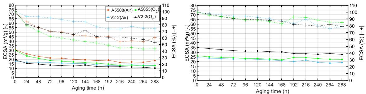
Figure 5-26 : Evolution de la surface active en  $m^2/g_{Pt}$  et en relative durant tout le protocole de vieillissement. Les courbes de gauche correspondent à l'évolution de la surface active à la cathode. Les courbes de droite correspondent à l'évolution de la surface active à l'anode. Les courbes en pointillé correspondent à l'évolution relative de la surface active en % et les courbes en trait plein correspondent à l'évolution en  $m^2/g$ .
