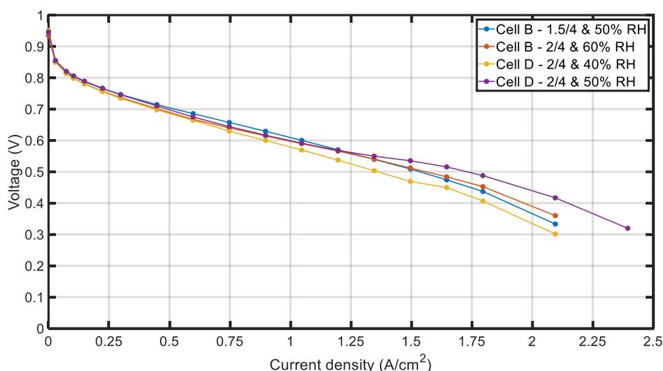
*Figure 4-6 : Meilleures courbes de polarisation à chaque humidité relative, pour une pression des gaz de 1,5 bar, entre les cellules B et D. Mesure faite à 70°C.*
