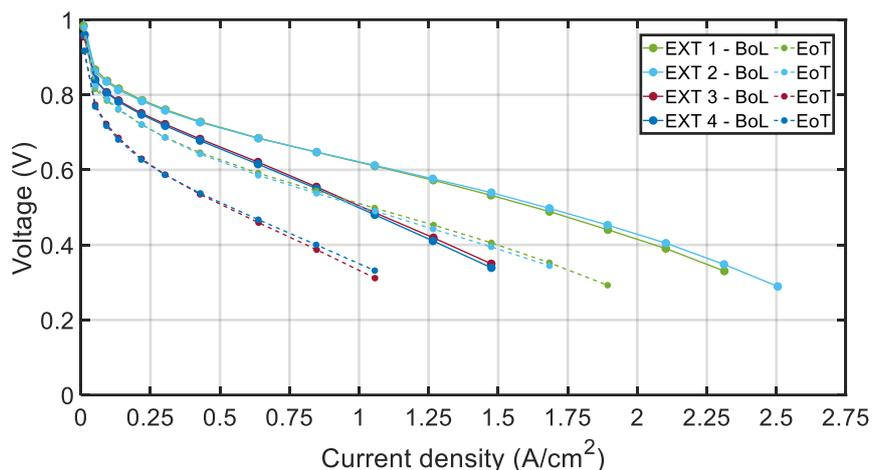
**Figure 5-9 :** Courbes de polarisation en début de vie et fin de test pour chaque assemblage EXT. Les courbes en trait plein correspondent aux courbes de polarisation en début de vie. Les courbes en pointillé correspondent aux courbes de polarisation de fin de vie. Tests réalisés avec la cellule segmentée de 25 cm<sup>2</sup>.
