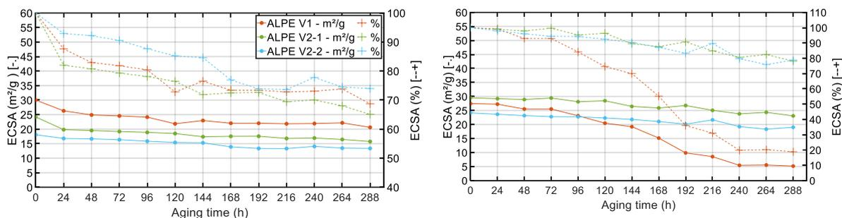
Figure 5-17 : Evolution de la surface active en  $\text{m}^2/\text{g}$  et en relative durant tout le protocole. Les courbes de gauche correspondent à l'évolution de la surface active à la cathode. Les courbes de droite correspondent à l'évolution de la surface active à l'anode. Les courbes en pointillé correspondent à l'évolution relative de la surface active en % et les courbes en trait plein correspondent à l'évolution en  $\text{m}^2/\text{g}$ .
