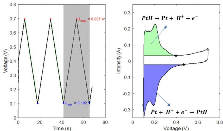
Figure 2-10 : Gauche : voltamétrie cyclique composée de deux cycles de variation linéaire du potentiel de la cellule entre 0.1 et 0.7 V en fonction du temps. A droite : voltamogramme réalisé entre 0.1 et 0.7 V. La zone verte correspond à la zone d'oxydation de l'hydrogène et la zone bleue correspond à la zone de réduction de l'hydrogène.
