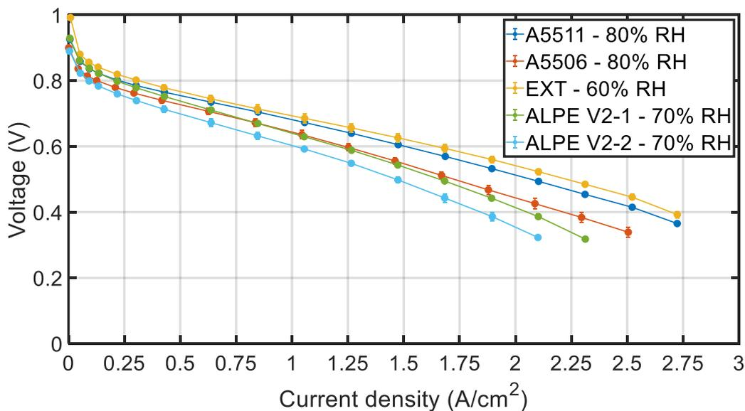
Figure 4-17 : Meilleures courbes de polarisation pour l'étude comparative sous air. Chaque AME fonctionne avec une stœchiométrie de 1,5/4 (H<sub>2</sub>/Air) à P = 2 bar et T = 80°C avec la cellule de 25 cm<sup>2</sup>.
