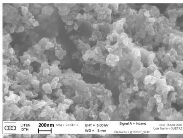
Figure 1-11 : Image par Microscopie Electronique à Balayage (MEB) d'une couche catalytique à base de Pt/C. Image tirée de [79].
