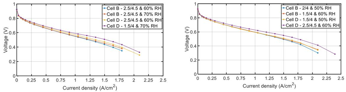
Figure 4-10 : Meilleures courbes de polarisation obtenues entre les cellule A et B à  $T = 80^{\circ}\text{C}$ . Gauche :  $P = 1,5 \text{ bar}$  ; droite :  $P = 2 \text{ bar}$ .
