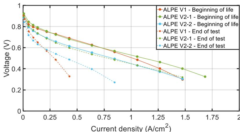
**Figure 5-14** : Courbes de polarisation en début de vie et fin de test pour chaque version ALPE. Les courbes en trait plein correspondent aux courbes de polarisation en début de vie. Les courbes en pointillé correspondent aux courbes de polarisation de fin de vie. Tests réalisés avec la cellule segmentée de 25 cm<sup>2</sup>.
