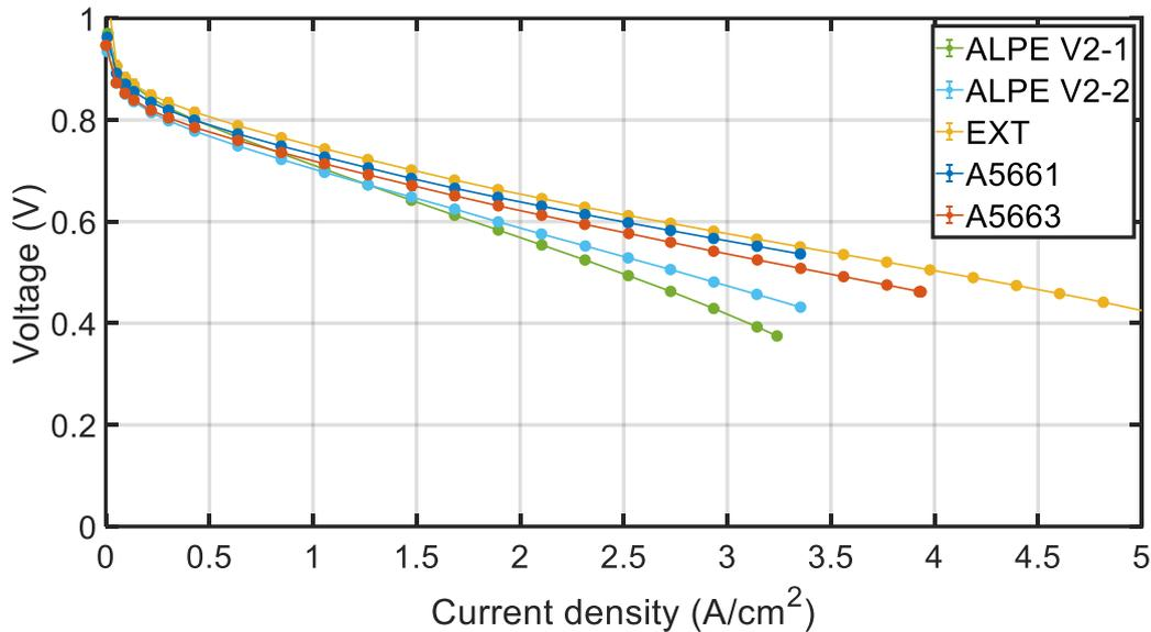
Figure 4-19 : Meilleures courbes de polarisation pour l'étude comparative sous oxygène. Chaque AME fonctionne avec une stœchiométrie de 1,5/1,75 ( $H_2/O_2$ ) à  $P = 2$  bar,  $T = 80^\circ C$  et  $HR = 60\%$  avec la cellule de  $25\text{ cm}^2$ .
