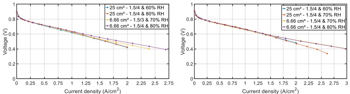
**Figure 4-14 :** Comparaison des meilleurs courbes de polarisations entre les cellules de 7 et 25 cm<sup>2</sup>. Courbes de gauche à 1,5 bar et courbes de droite à 2 bar. Les cellules sont maintenues à 80°C.
