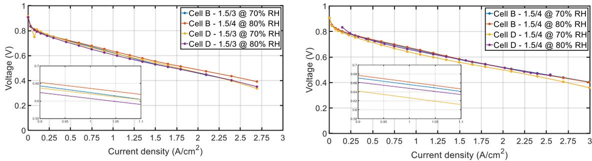
Figure 4-12 : Meilleures courbes de polarisation obtenues à  $T = 80^{\circ}\text{C}$  entre les cellules A et B. Gauche :  $P = 1,5 \text{ bar}$  ; droite :  $P = 2 \text{ bar}$ . Zoom des courbes de polarisation entre 0,90 et 1,10  $\text{A}/\text{cm}^2$
