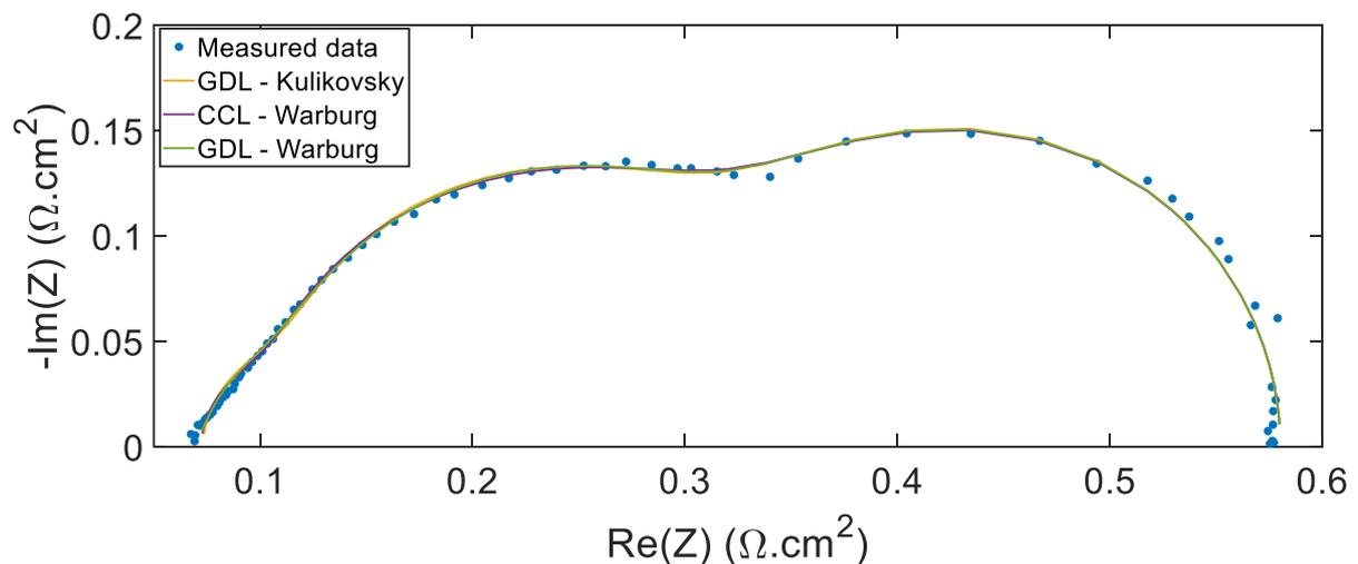
Figure 3-4 : Diagramme de Nyquist expérimental mesuré in operando (0,5 A/cm<sup>2</sup> et 0,68 V, sous H<sub>2</sub>/air) avec la cellule A1 dans les conditions de fonctionnement décrites dans la section 3.3.3- et courbes de modélisation obtenues avec les différents circuits électrique équivalent représentés dans la Figure 3-2 [4].
