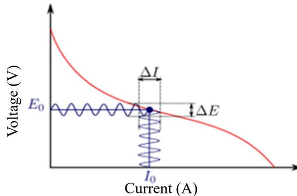
Figure 2-2 : Représentation schématique du principe de la mesure de la spectroscopie d'impédance sur un point de mesure de la courbe de polarisation avec une variation  $\Delta I$  et une réponse  $\Delta E$ . Image modifiée de [10].
