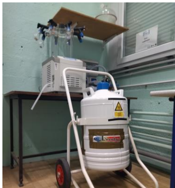
Azote liquide utilisée pour la préparation des cubes de sol
