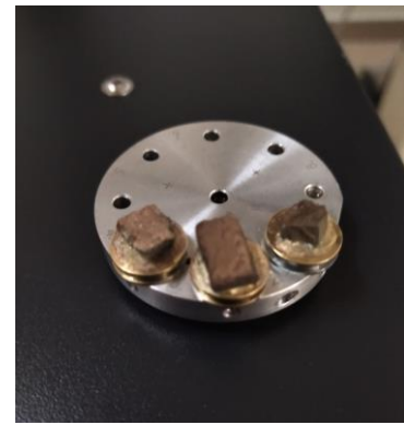
Éprouvettes préparées avant observation au MEB
