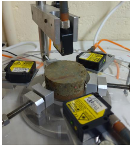
Figure II.31. Essais de retrait adapté de la norme française NF XP P94-060-2 (1997).
