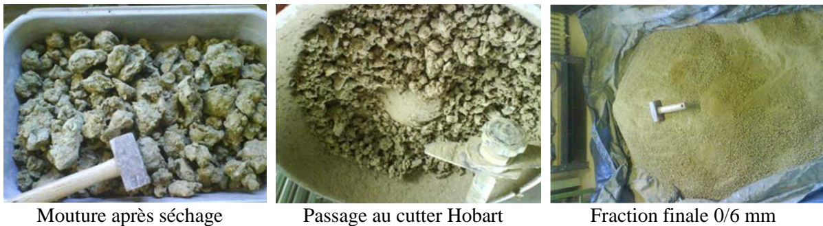
Figure II.4. Préparation de l'argile avant essais de laboratoire (Froumentin, 2012).
