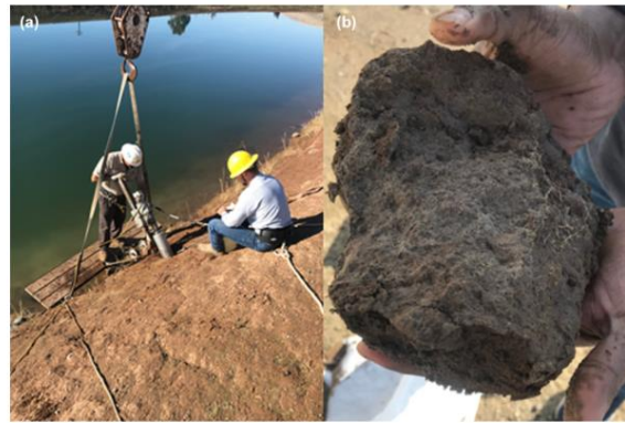
Figure I.33. Campagne de prélèvement du sol dans les sections du canal traitées à la chaux (a), échantillon traité à la chaux (b) (Akula et al., 2020).
