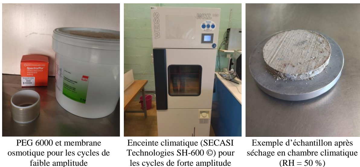
Figure II.34. Matériel nécessaire à la simulation des cycles de séchage et d'humidification.
