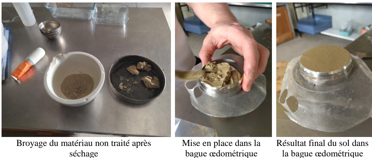
Figure II.30. Préparation du sol non traité afin d'obtenir la courbe vierge du matériau.
