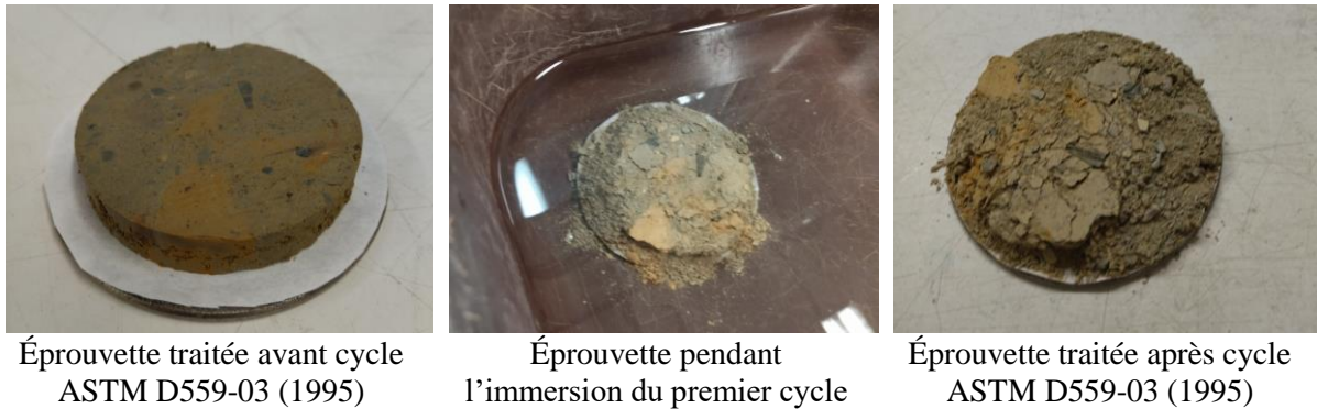
Figure II.35. Éprouvette traitée soumise à un cycle ASTM D559-03 (1995).
