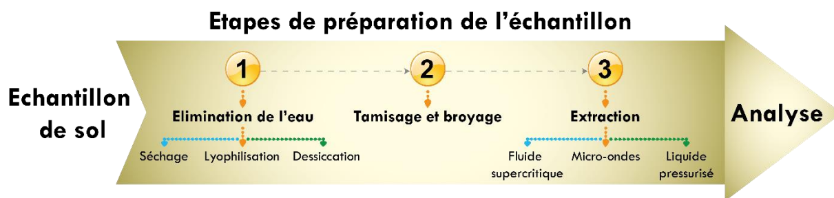
Figure 4 : Etapes principales de préparation d'un échantillon de sol avant son analyse.
