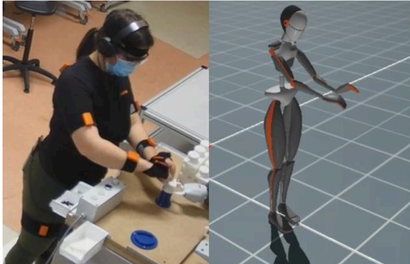
Figure 27 : A/ Centrales inertielles posées sur le corps d'un participant dans la modalité COB ; B/ Représentation de l'avatar sur le logiciel Xsens MVN
