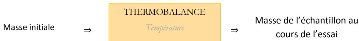
Figure A. 14 : Données en entrée et en sortie de la thermobalance (en caractères droits : valeurs imposées ; en caractères italiques : valeurs mesurées).
