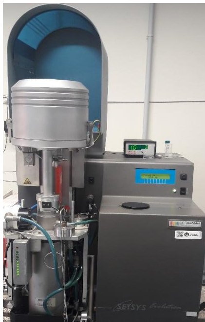
Figure 2.2 : Photo de la thermobalance Setsys Ev 1750 TGA – SETARAM utilisée pour l'ATG sous air .
