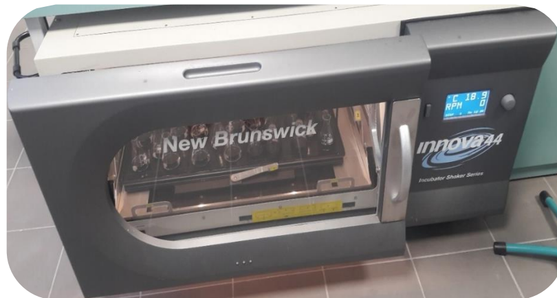
Figure 2.7 : Photo de l'étuve munie d'un plateau d'agitation utilisée pour l'évaluation des isothermes d'adsorption.
