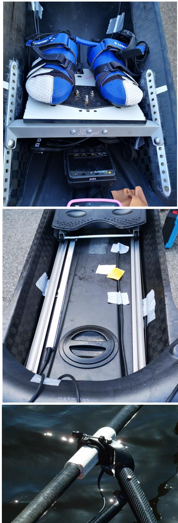
Figure 32 : Barre de pied instrumentée et Logger Peach (affichage de cadence) ; capteur de position de coulisse ; dame de nage instrumentée
