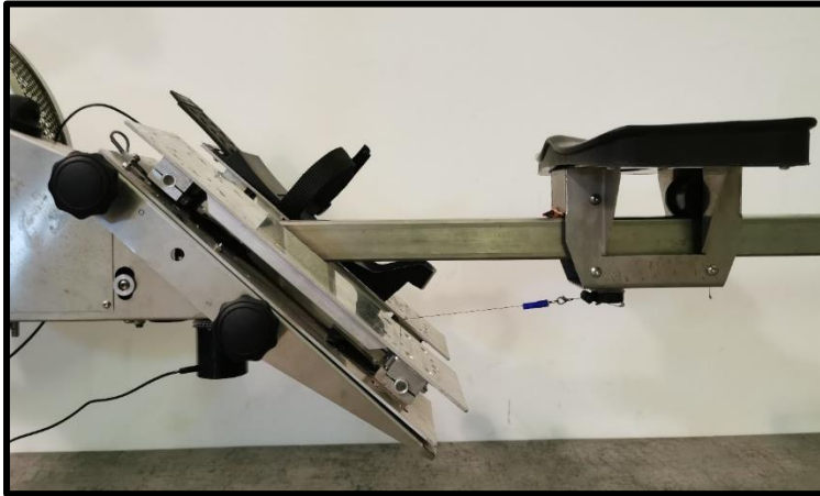
Figure 23 : Capteur de force Biorow et capteur de position du siège
