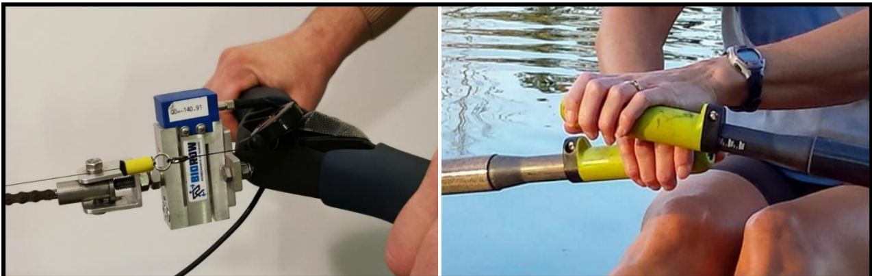
Figure 24 : (A) Capteur de force et de position de la poignée Biorow et (B) Chevauchement des avirons sur bateau (FFAviron.fr)
