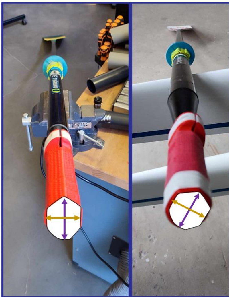
Figure 35 : Réglage des poignées sur le manche : comme lors de l'étude à gauche ; après exposition prolongée à droite
