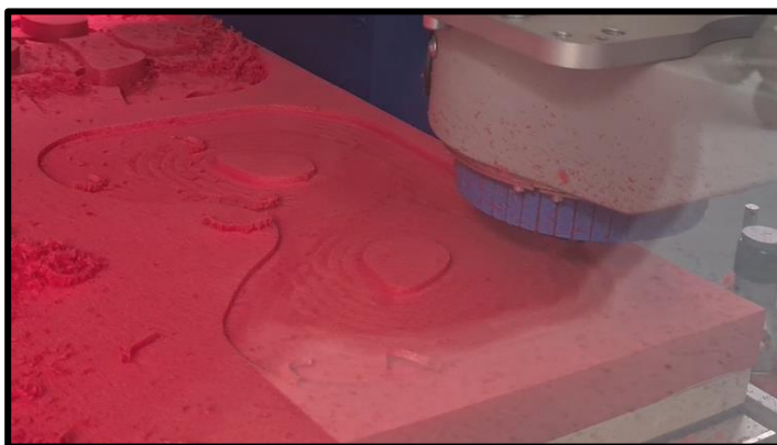
Figure 42 Fabrication d'un coussin de siège
