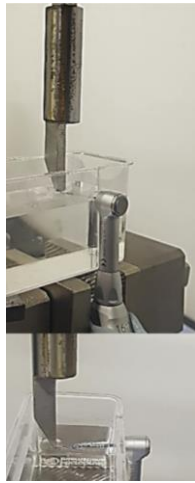
Figure 1.22 Banc d'essai de flexion avec un bain d'eau chaude (Oh et al., 2020).
