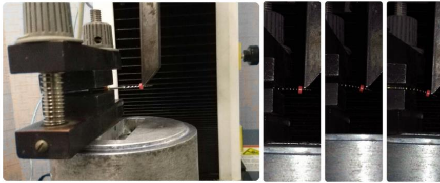
Figure 1.21 L'essai de flexion « cantilever » (Ismail et al., 2020).
