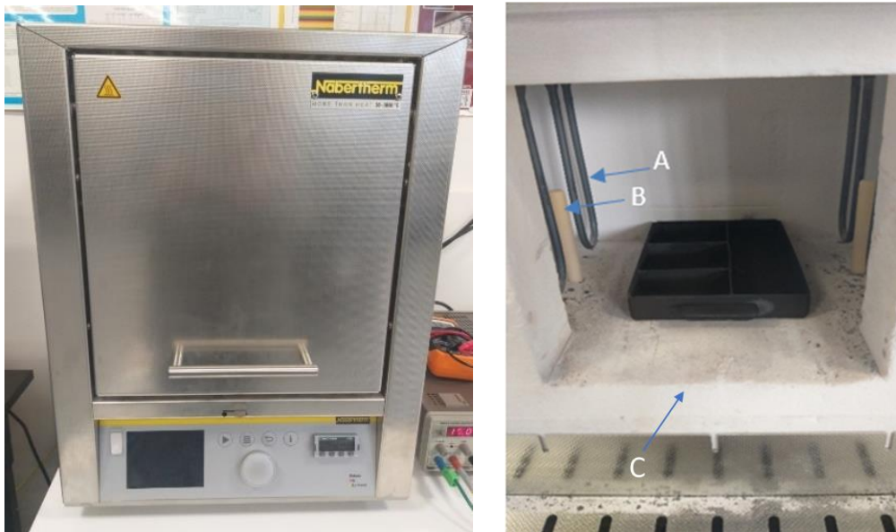
Figure 2.16: Four utilisé pour le traitement thermique des échantillons testés avec le support en acier-inoxydable. A : Éléments chauffants en disiliciure de molybdène (MoSi2) ; B : Thermocouple ; C : chambre du four avec une isolation en matériau fibreux.
