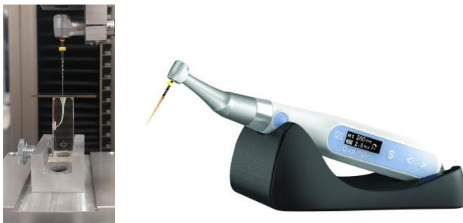
Figure 4.3 À droite : contre-angle endodontique Dual Move utilisé lors des essais de P/R (source Micro-Mega). À gauche : position initiale de l'instrument endodontique avec une cale de 1 mm en place (document personnel).
