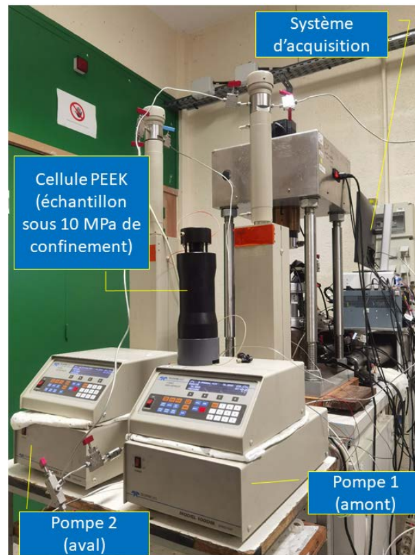
Figure 3. 6: Dispositif expérimental pour les essais de perméabilité en cellule PEEK
