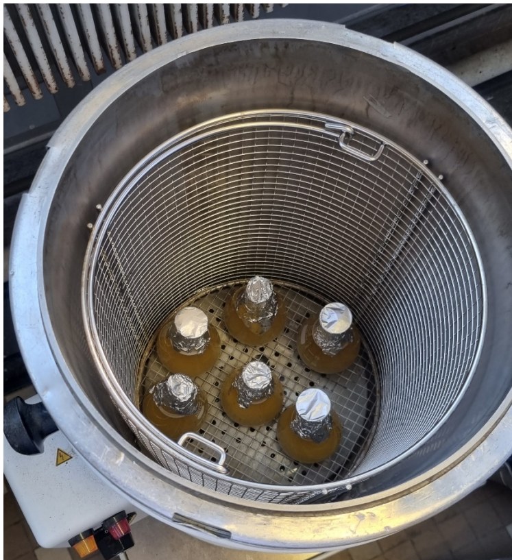
Annexe 19 : autoclave (stérilisation du milieu gélosé).
