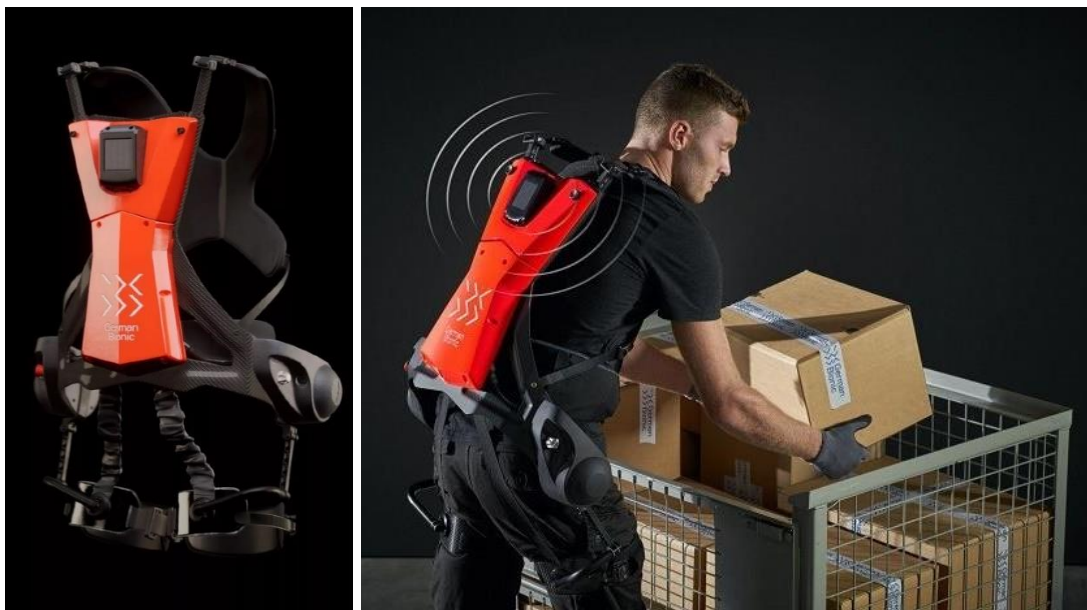
Figure 4 : RAP d'assistance du dos (Cray X, German Bionics, Germany). Deux moteurs sont disposés de part et d'autre des hanches pour assister leur extension via une paire de bretelles et des sangles au niveau des cuisses. La batterie et l'ordinateur qui commandent les moteurs sont situés dans le dos de l'utilisateur.
