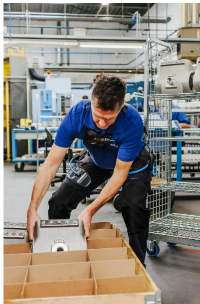
Figure 2 : DAP rigide d'assistance du dos (Laevo V2, Laevo Exoskeletons, Pays-Bas). L'assistance est fournie par la mise en tension de ressorts situés entre les hanches et le thorax lors de la flexion des hanches grâce aux interfaces de contact situées au niveau des cuisses et du thorax.
