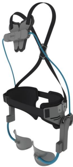
Figure 2 : DAP rigide d'assistance du dos (Laevo V2, Laevo Exoskeletons, Pays-Bas). L'assistance est fournie par la mise en tension de ressorts situés entre les hanches et le thorax lors de la flexion des hanches grâce aux interfaces de contact situées au niveau des cuisses et du thorax.
