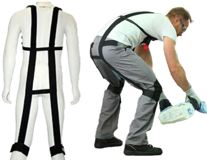
Figure 3 : DAP textile d'assistance du dos (CORFOR® V2, France). L'assistance est donnée lors de la mise en tension des bandes élastiques attachées aux épaules et aux genoux et mises en tension lors de la flexion des hanches et du rachis.
