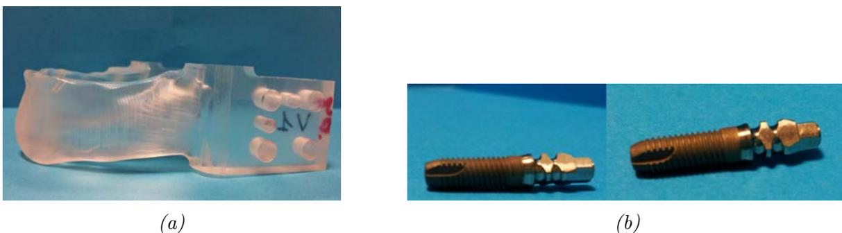
FIGURE 2.12 – Fabrication d'une mandibule en PMMA avec taraudage pour les implants, avec inclinaison des implants postérieurs de  $45^\circ$  (a) et implants droits et inclinés, de la marque Euroteknika<sup>®</sup> (b) [51].
