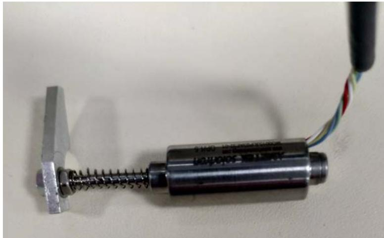
*FIGURE A.7 – Palpeur de déplacement avec le ressort.*
