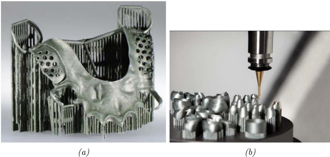
FIGURE 3.15 – Exemple de supports de fabrication pour une prothèse partielle amovible (a) et méthode de conception hybride, pour la finition, avec l'ajout du fraisage CNC (b) [123].
