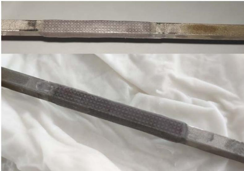
FIGURE 5.10 – Barre lattice avec infiltration de la résine acrylique au niveau de la partie centrale architecturée.
