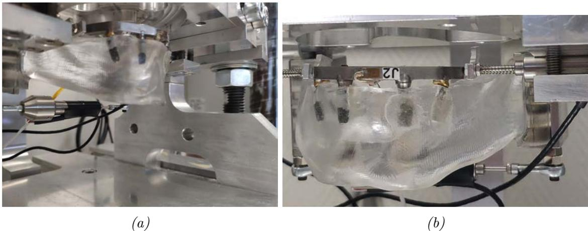
FIGURE 2.28 – Capteur d'écartement repositionné, en vue de profil (a) et vue de face (b).
