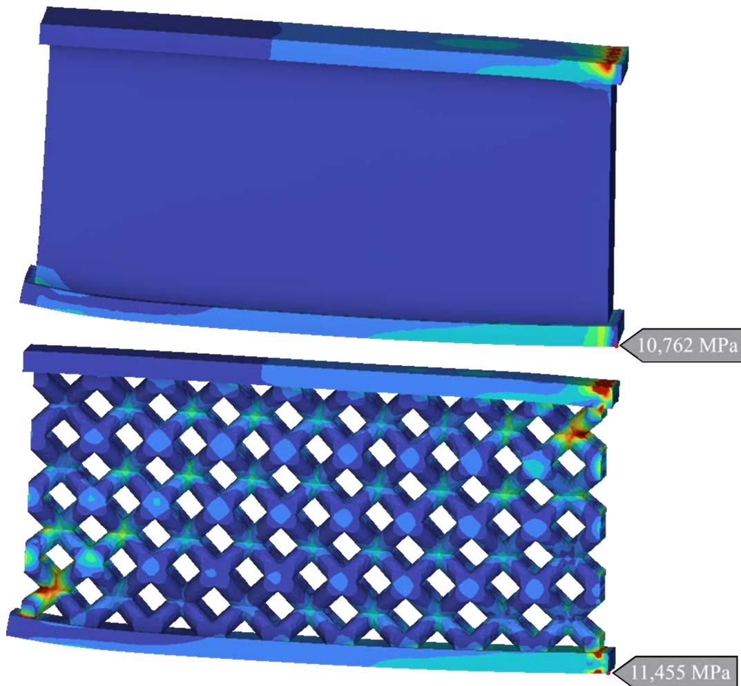
FIGURE B.4 – Comparaison des contraintes équivalentes de von Mises [MPa] entre le modèle homogénéisé et le modèle complet avec la structure *lattice*.
