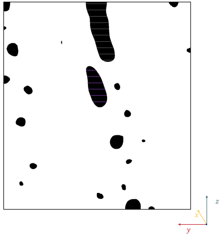
Figure 4: Image binaire obtenue après un traitement d'image (décrit dans le chapitre 3) réalisé sur la cartographie de ségrégations de l'échantillon C3_A.
