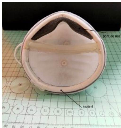
FIGURE 2.24 – Système d'isolation choisi pour les locuteurs enregistrés pour le travail de recherche d'Amélie Elmerich. Cette figure montre également un pont de nez.
